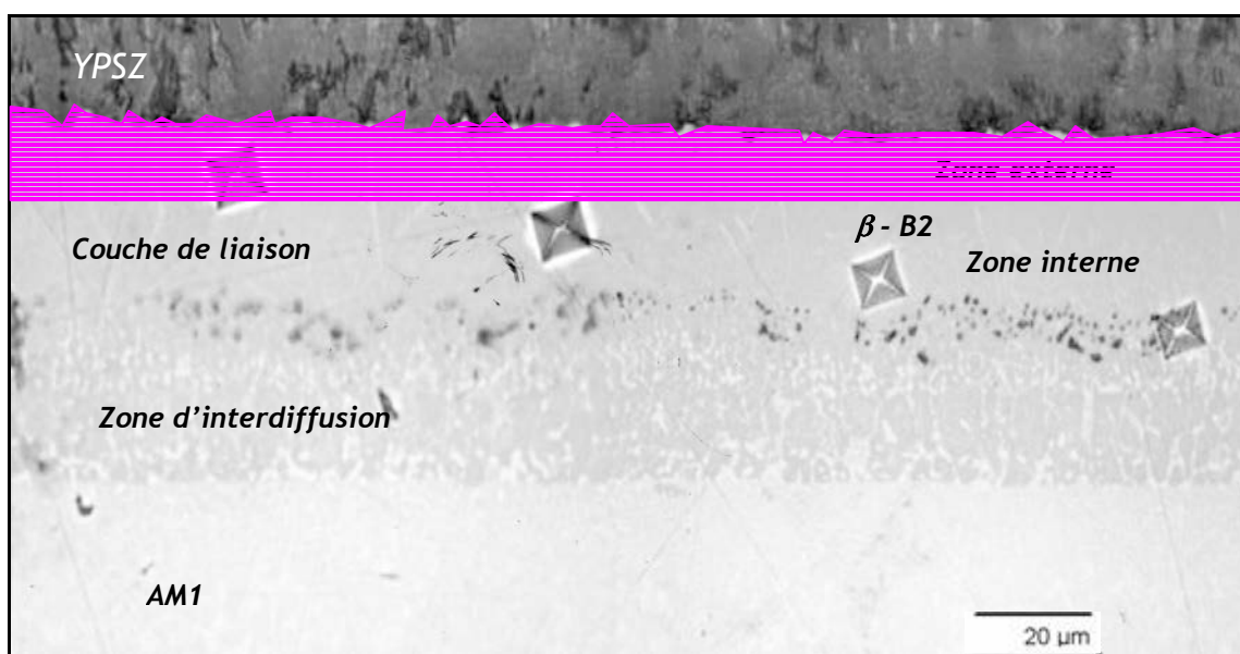
Figure 216 : Empreintes de microindentation instrumentée réalisées à température ambiante sur le système barrière thermique brut d'élaboration (microscope optique).
