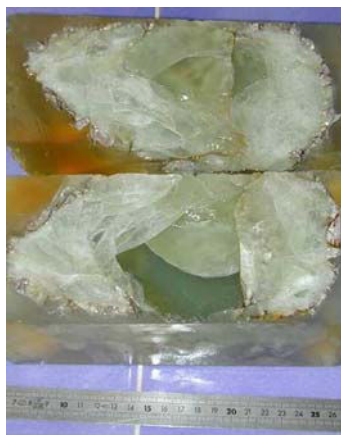
Figure 22 : Photographie du bloc inclus dans la résine et tronçonné en deux parties.
