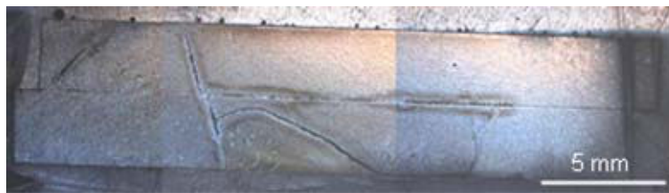
Figure 108 : Photographie prise au microscope de l'ensemble de la fissure modèle composée de 2 pastilles de verre horizontales, qui se sont fissurées au cours de l'expérience.
