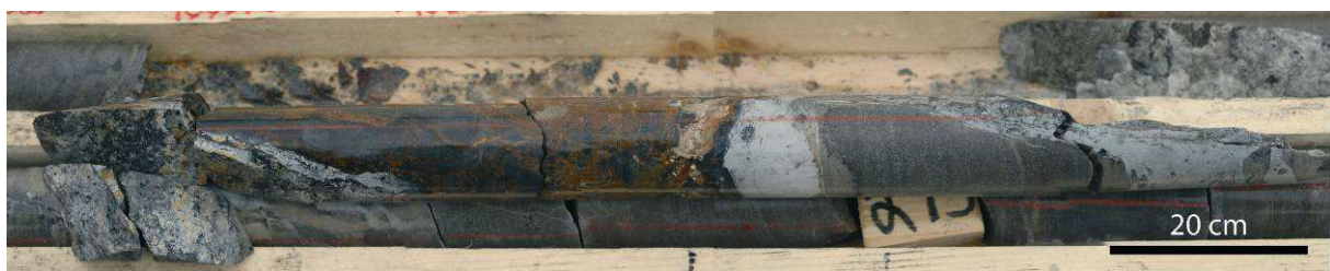
Figure 3-16 : Brèche à dravite, quartz hydrothermal et uranium du gisement de P-Patch. Les analyses chimiques effectuées montrent que cette brèche est contemporaine des premiers épisodes de minéralisation du bassin d'Athabasca. Elle est associée à un système de veines à quartz hydrothermal et dravite
