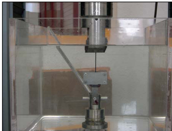
Figure 4.12 : Système de préhension des scaffolds tissés Mersilk.
