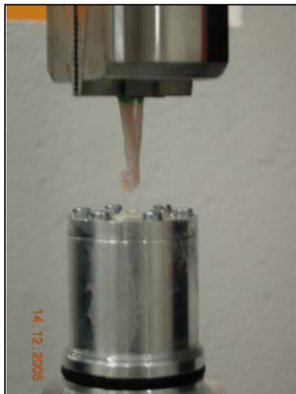
Figure 4.31 : Description des mors utilisés pour les tests biomécaniques.
