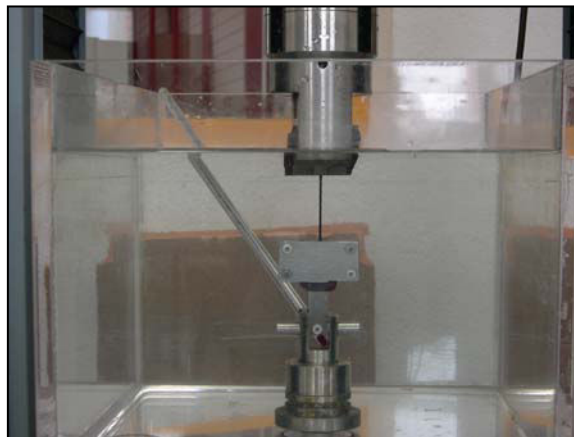
Figure 4.12 : Système de préhension des scaffolds tissés Mersilk.
