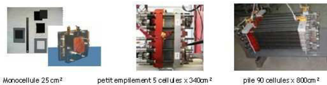
Figure 5.1 : Photos des trois piles à combustible étudiées dans le projet SPACT 80.
