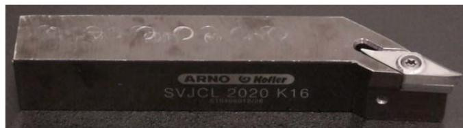
Figure 25 : Outil de tournage (porte-plaquette + plaquette)
