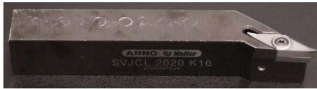
Figure 46 : Outil de tournage (porte-plaquette + plaquette)
