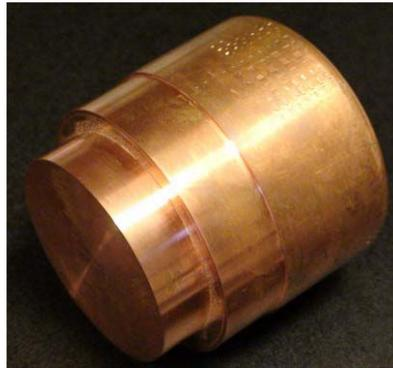
Figure 27 : Éprouvette de cuivre CuC<sub>2</sub> utilisée lors de la première étape.
