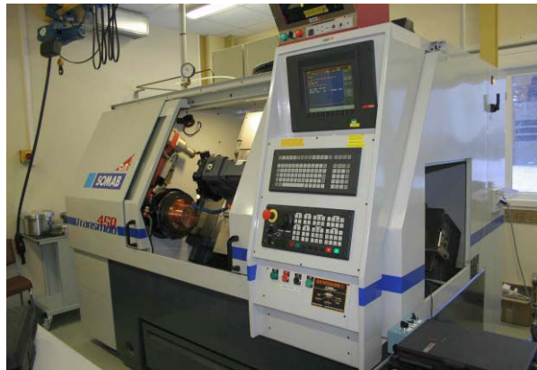
Figure 28 : Tour SOMAB T450 sur le site du CEA
