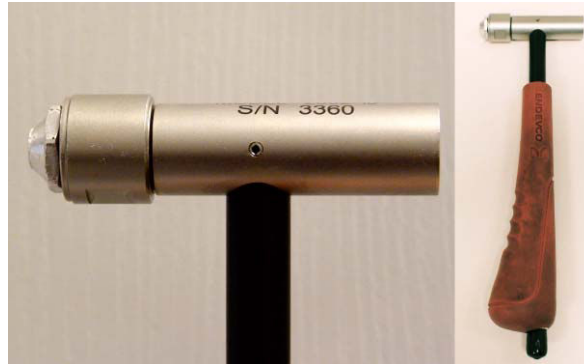
Figure 44 : Marteau d'impact ENDEVCO 2302-10 (sensibilité 2.29mV/N)
