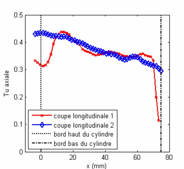
figure 93 Evolution des intensités turbulentes axiales obtenues sur les coupes longitudinales (1 et 2)
