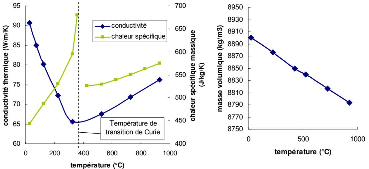
figure 130 Evolution des propriétés thermophysiques du nickel avec la température
