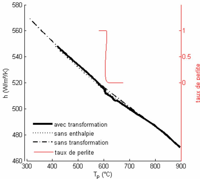
**figure 67 Evolution du coefficient de transfert de chaleur avec la température au point « peau 3 » calculée avec et sans transformations de phases et en considérant une enthalpie de transformation de phases nulle (l'évolution du taux de perlite est également représentée)**
