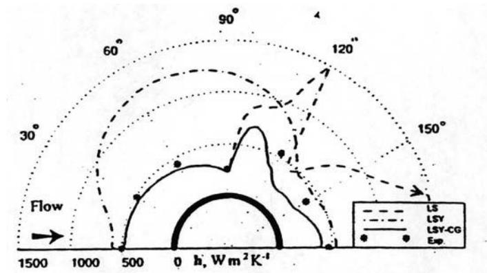
figure 12 Comparaison des coefficients de transferts locaux  $h_{\theta}$  calculés avec différents modèles  $k-\varepsilon$  et des résultats expérimentaux pour le cas de figure étudié par Lior & al [50],  $Re = 3,16 \cdot 10^5$
