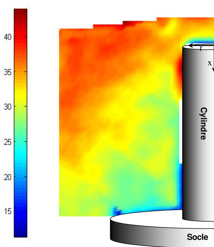
*figure 91 Carte d'intensité turbulente de l'écoulement (%)*
