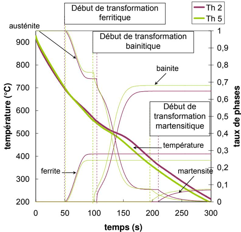
**figure 141 Evolution de température et de microstructure dans la partie inférieure (thermocouples 2 et 5) du cylindre plein trempé à l'hélium 4,5 bars**
