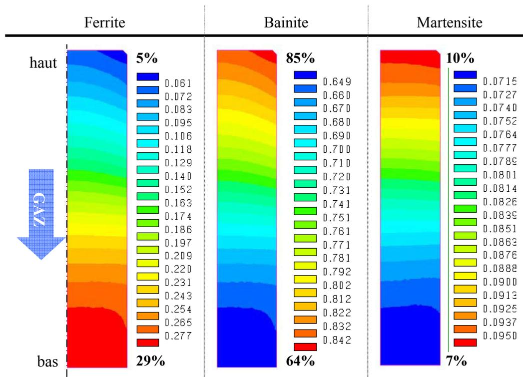
**figure 144** Cartes de proportion de phases dans l'éprouvette cylindrique pleine en acier 27MnCr5 en fin de trempe ( $t = 490$  s) à l'hélium 4,5 bars
