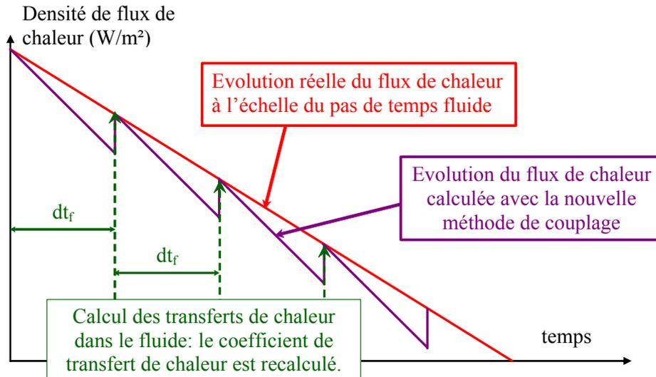
**figure 43 Comparaison schématique de l'évolution temporelle de la densité de flux de chaleur réellement transféré et calculé avec le couplage Fluent – Sysweld à l'échelle du pas de temps fluide avec la méthode de couplage améliorée**
