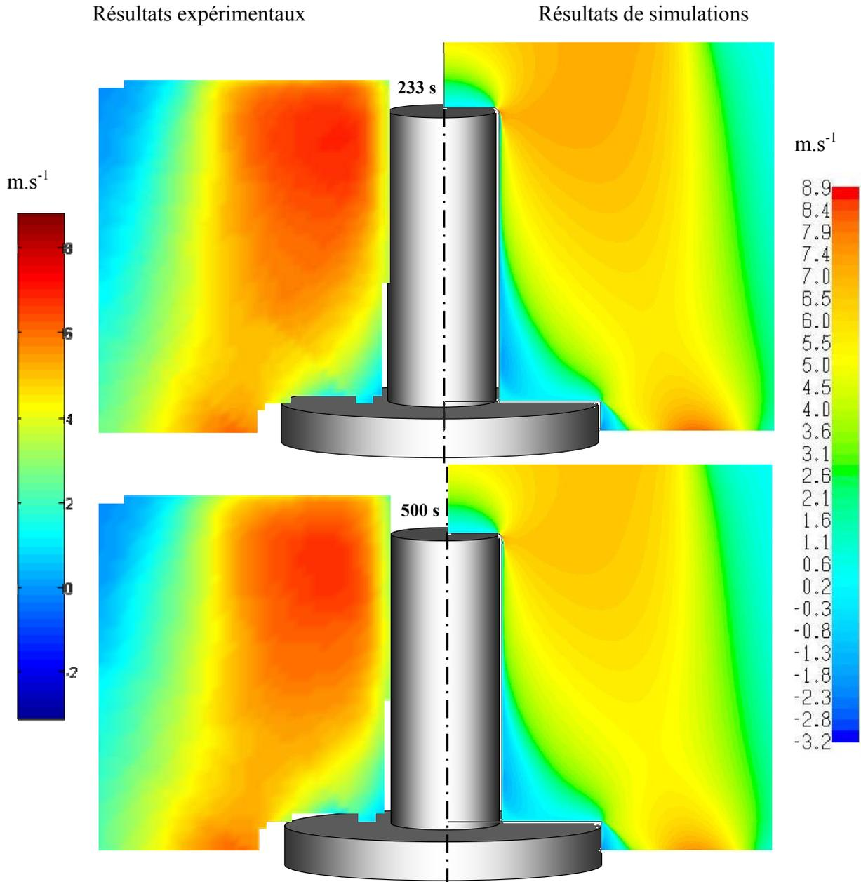
**figure 131** Cartes de vitesses axiales mesurées et calculées à quatre instants de la trempe identifiés par la température maximale du cylindre
