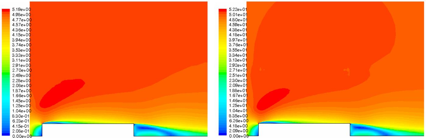
figure 33 Champ de vitesses (norme en  $m.s^{-1}$ ) autour du cylindre obtenue pour  $Re_d = 10^5$  (à gauche) et  $Re_d = 10^6$  (à droite)
