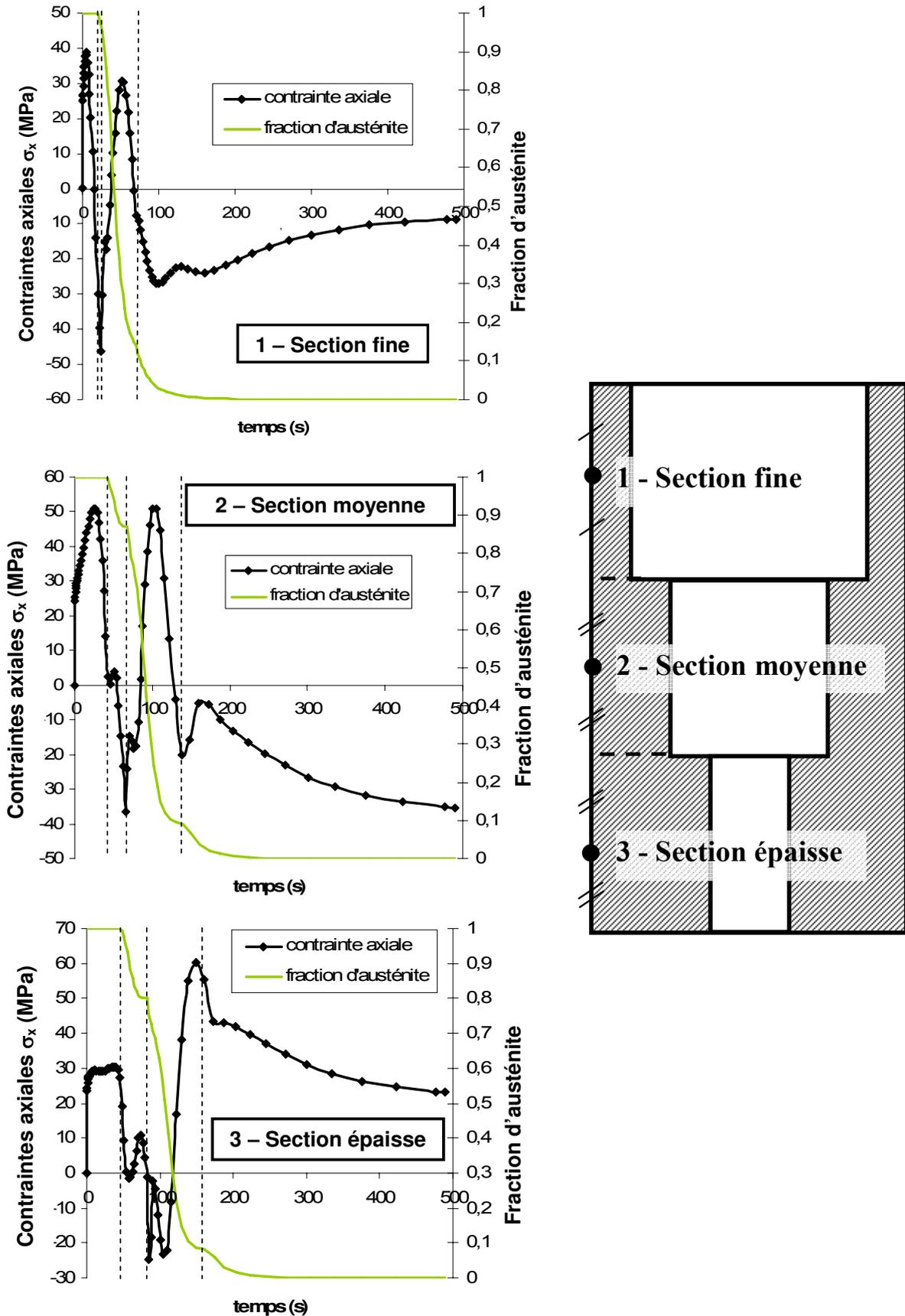
figure 161 Evolutions temporelles de la contrainte axiale (en MPa) et de la fraction d'austénite en 3 points de l'éprouvette creuse trempée à l'hélium à 4,5 bars
