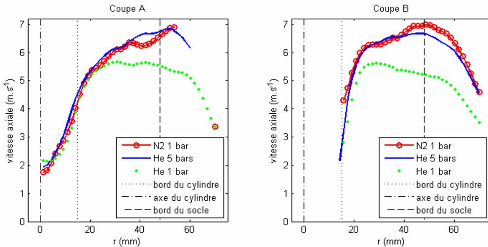
figure 94 Evolution de la norme de la vitesse et des coordonnées axiale et radiale le long des coupes transversales A et B pour les trois différents couples gaz/pression de trempe utilisés
