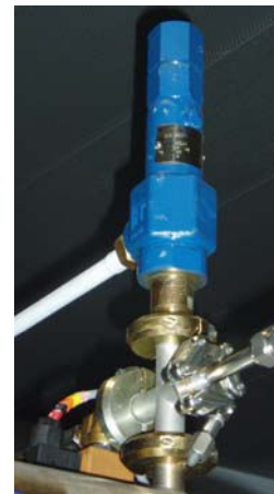
figure 83 Vanne d'injection des particules de ZrO_2 dans la cellule de trempe
