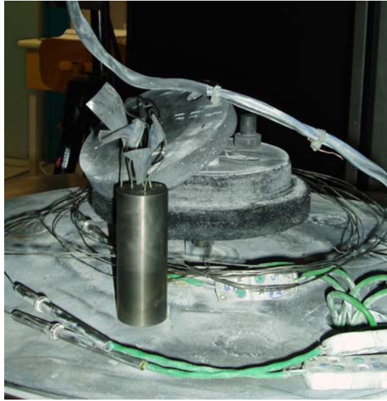
figure 102 Photographie d'un cylindre équipé de thermocouples
