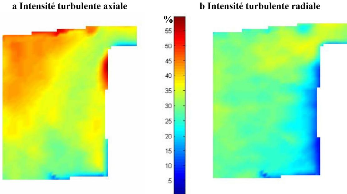
figure 92 Distributions d'intensités turbulentes axiale (a) et radiale (b) de l'écoulement (en %)
