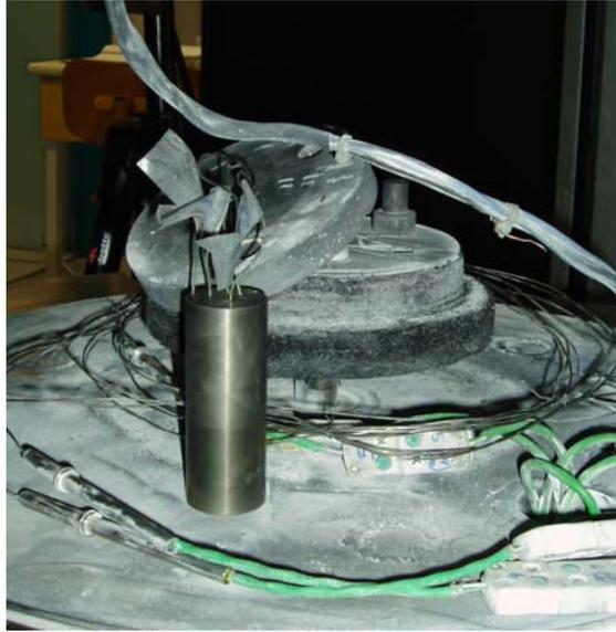
figure 102 Photographie d'un cylindre équipé de thermocouples
