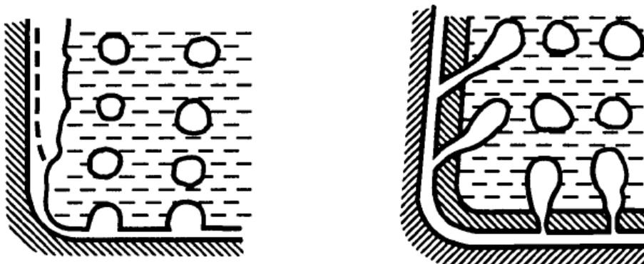
Figure 1.16 : Répartition spatiale des phases dans le modèle de WECHSL
