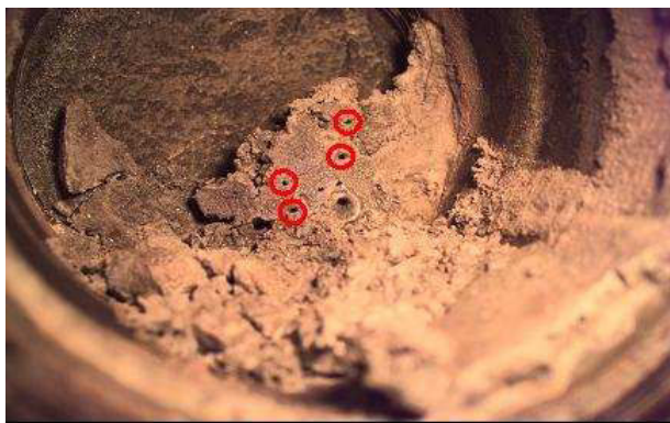
Figure 2.14 : Observation des orifices de cheminées dans la croûte post mortem de l'essai 2
