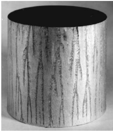
Figure 3.3 : Visualisation des « freckles » à la surface d'un lingot – Image extraite du site Internet de C. Beckermann
