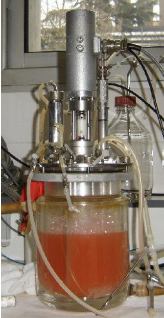
Figure III.13. Bioréacteur de 3 L (a) et conditions opératoires (b) utilisées pour les cultures comparées sur différentes sources de glycérol.
