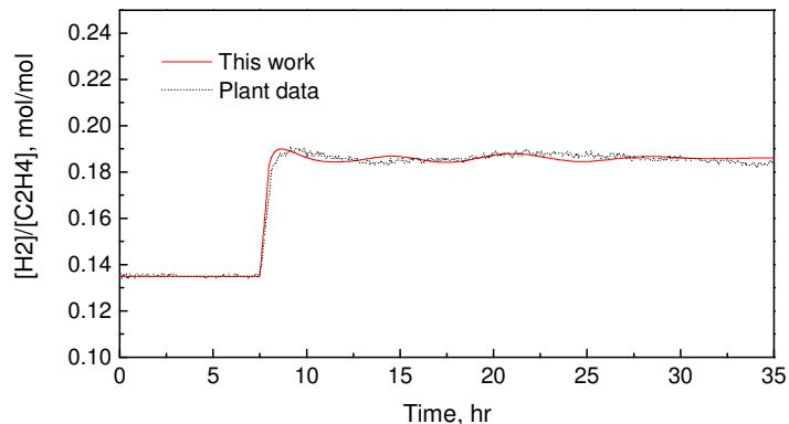
图7.30 切换过程气相氢气乙烯摩尔比
