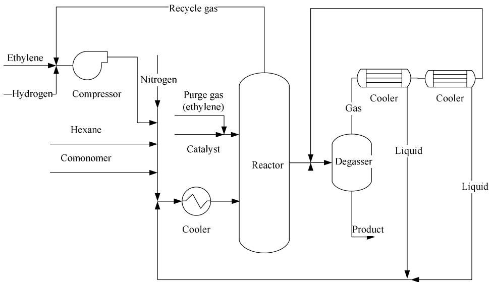
图2.2 乙烯气相聚合工段流程图
