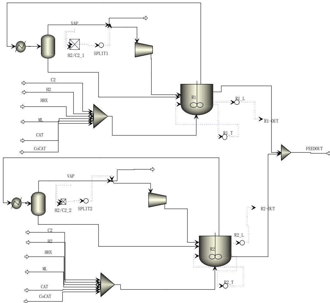
图7.1 乙烯淤浆聚合装置动态模拟流程
