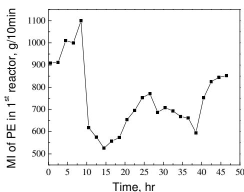
图2.7 牌号 S2-S3 第一反应器 MI 变化
