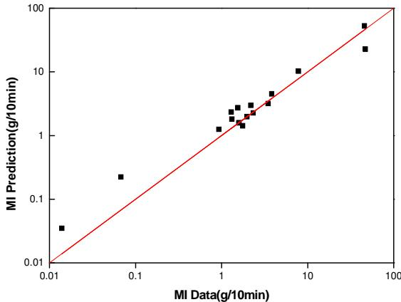
图2.11 Bremner-Rudin 模型预测值与实测的比较
