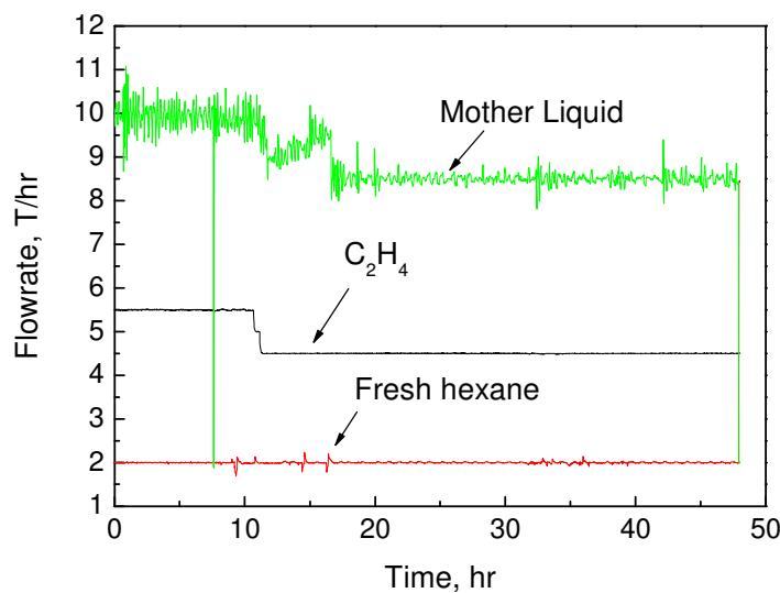
图7.3 乙烯、己烷及母液进入第一反应器的流量
