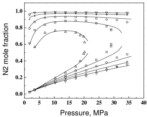
图3.17 氮气-己烷体系的汽液平衡计算值和文献值<sup>[6969]</sup>比较
