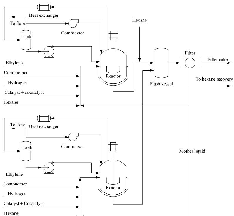
图2.1 乙烯淤浆聚合工段（串联）流程示意
