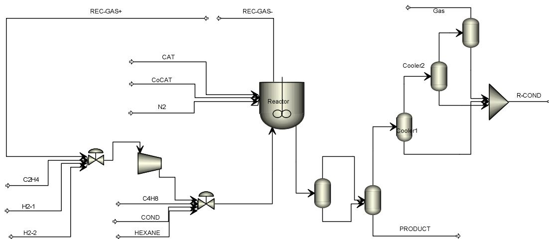
将稳态模型通过 File->Send to->Aspen Dynamics-Flow Driven 导入至 Aspen Dynamics，Aspen Dynamics 将自动增加 RCSTR 模块的控制，其控制参数包括反应器温度、压力以及料位。
