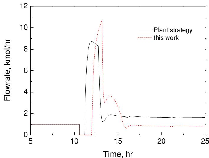
图7.19 第一反应系统气相放空量比较
