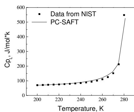
图3.2 乙烯饱和液相热容计算值和文献比较
