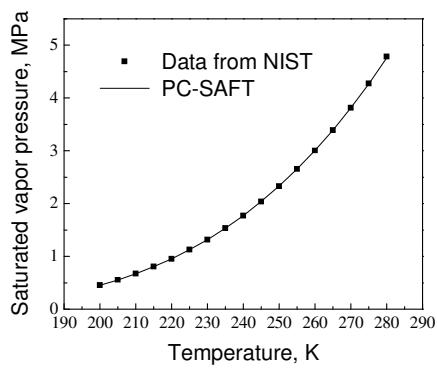
图3.1 乙烯饱和蒸汽压计算值和文献值比较
