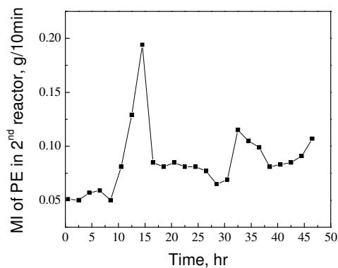
图2.8 牌号 S2-S3 第二反应器 MI 变化
