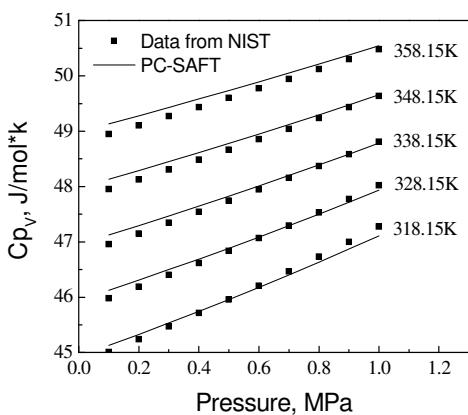
图3.3 乙烯气相热容计算值和文献值比较
