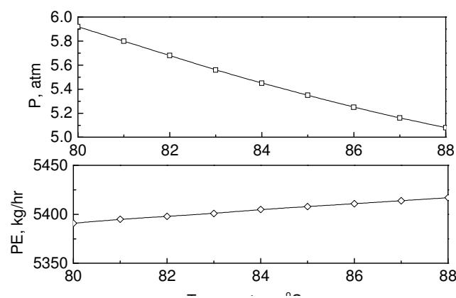
图5.13 反应器压力、聚合物生成量随温度的变化(乙烯进料恒定)
