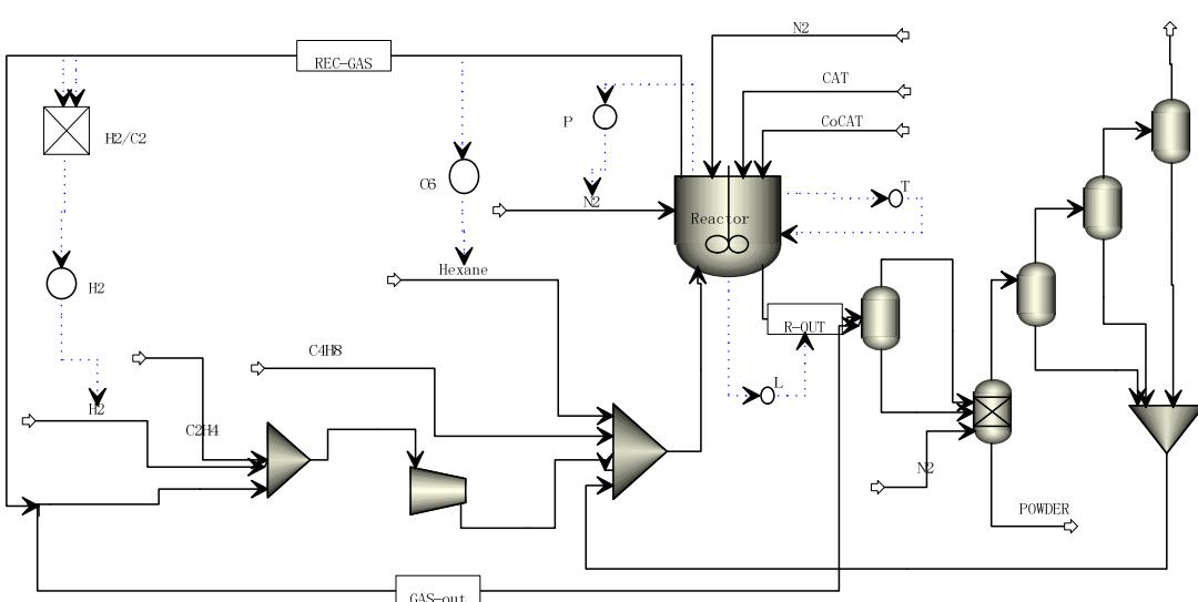
图7.21 工业乙烯气相聚合装置动态模型流程
