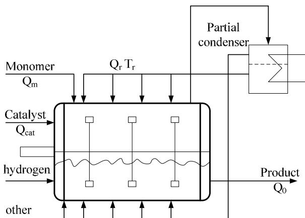
图1.13 Amoco 的卧式连续搅拌床反应器
