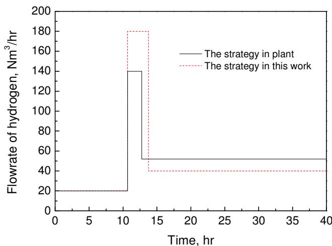
图7.17 两种策略氢气进料流量比较
