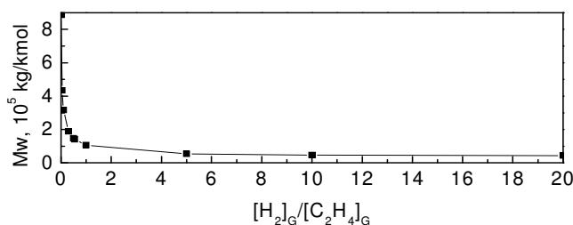
图5.18 氢气乙烯浓度比对聚合物分子量的影响（乙烯进料保持恒定）
