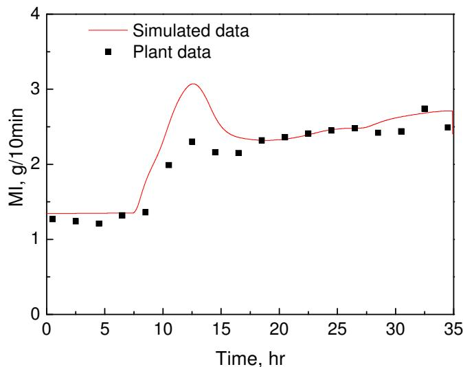
图7.28 反应器出口熔融指数模拟能果比較
