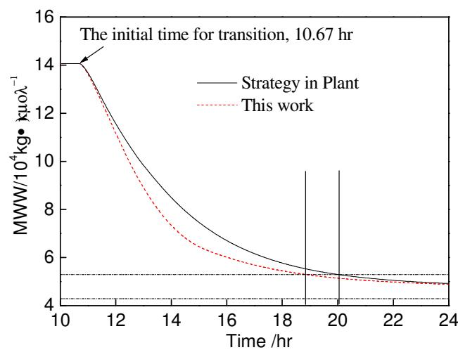
图7.20 反应器出口分子量的比较
