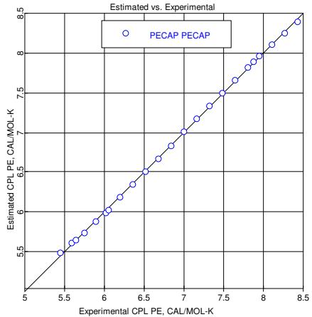
图3.13 PE热容计算值与实验值的比较
