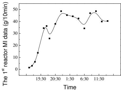
图2.5 牌号 P1 -P2 1<sup>st</sup> 反应器 MI 变化
