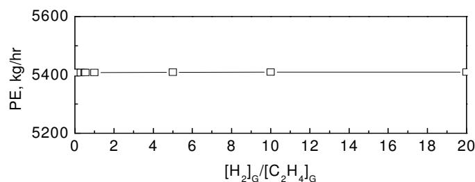
图5.19 气相氢气乙烯比对聚含量的影响（乙烯进料保持恒定）
