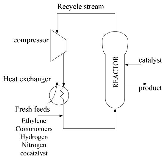
图1.1 乙烯气相聚合反应器流程
