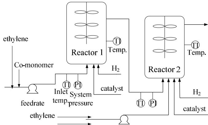
图1.9 乙烯溶液聚合过程
