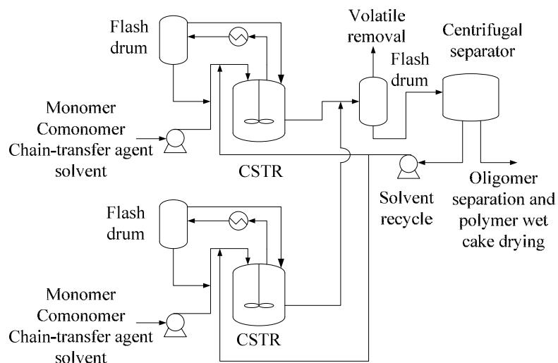
图1.7 乙烯淤浆聚合并联反应器流程
