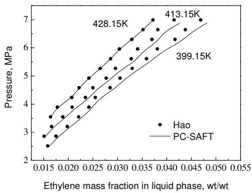
图3.18 乙 烯在聚乙 烯中的溶解度
