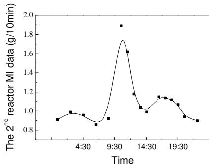
图2.4 牌号 S1-牌号 P1 2<sup>nd</sup> 反应器 MI 变化
