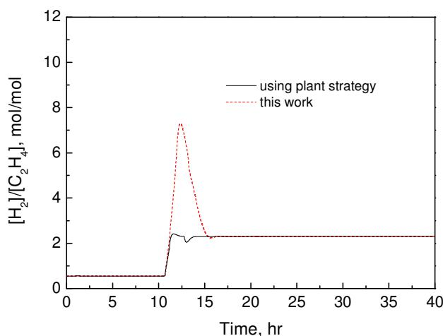
图7.18 第一反应器气相  $[H_2]/[C_2H_4]$  比较
