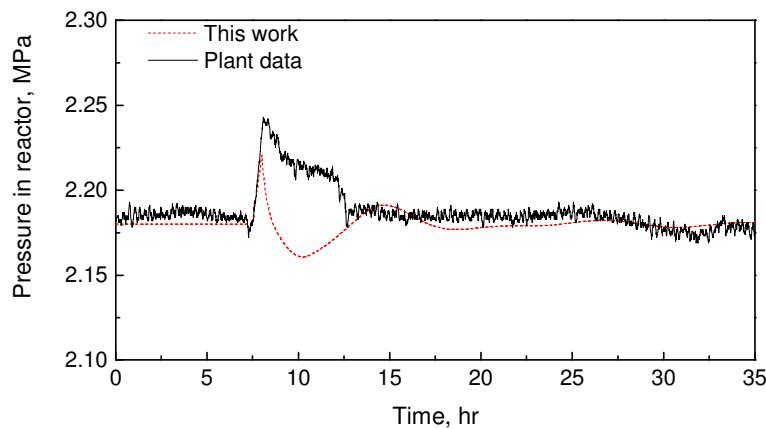
图7.31 切换过程反应器压力变化
