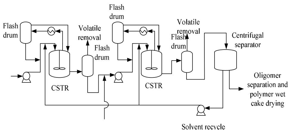
图1.8 乙烯淤浆聚合串联反应器流程
