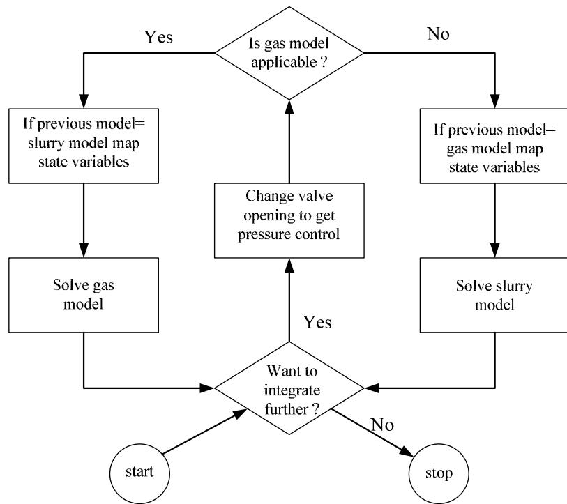
图1.6 DASSL 积分气相与淤浆态模型流程
