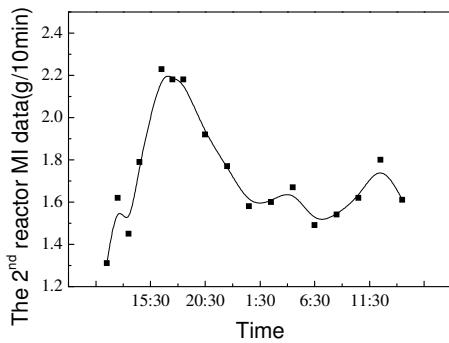
图2.6 牌号 P1-P2 2<sup>nd</sup> 反应器 MI 变化
