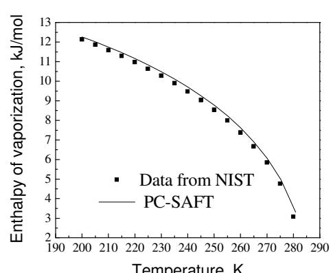
图3.4 乙烯摩尔蒸发焓计算值和文献值比较
