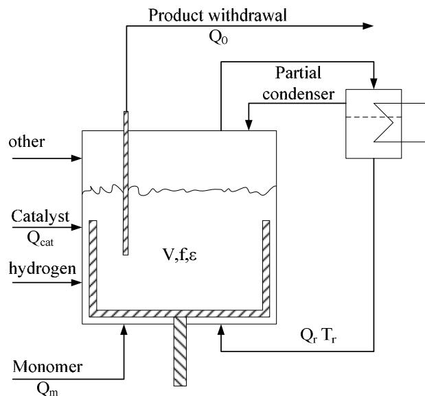
图1.12 BASF 的立式连续搅拌床反应器
