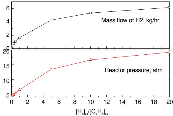
图5.17 氢气进料流量、反应器压力随氢气乙烯比的变化（乙烯进料保持恒定）
