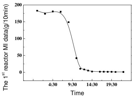
图2.3 牌号 S1-牌号 P1 1<sup>st</sup> 反应器 MI 变化
