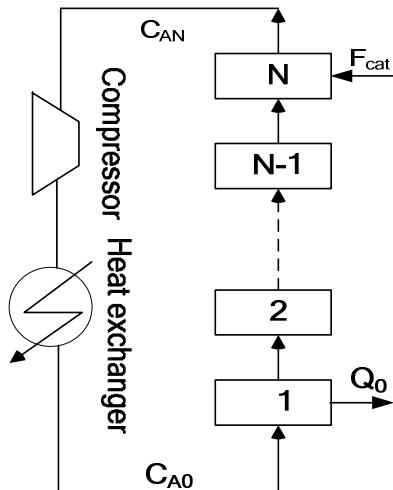
图1.4 乙烯气相聚合反应器串联模型
