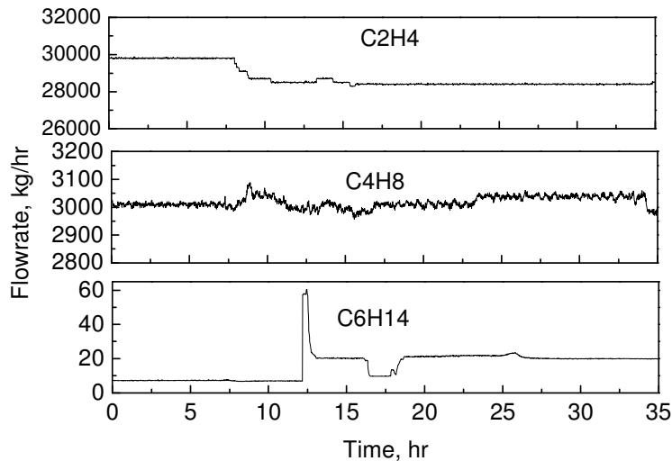
图7.22 乙烯、丁烯及己烷母液进入反应器的流量
