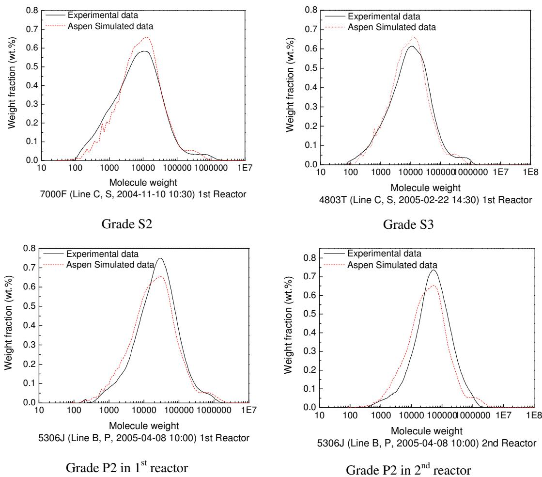
图5.6 分子量及分布模拟结果与测量值的比较
