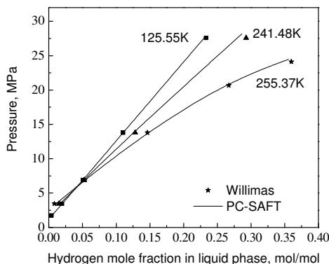
图3.16 氢气—乙烯汽液平衡计算值与文献值<sup>[68]</sup>比较
