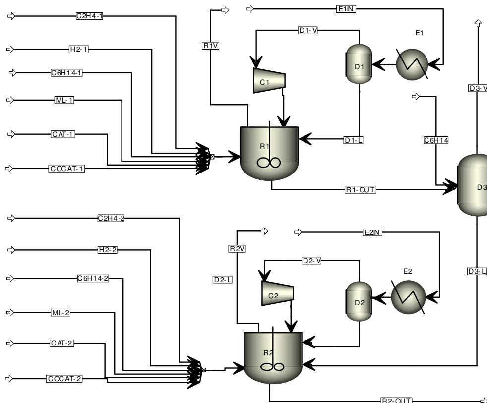
图5.4 乙烯淤浆聚合工艺串联生产模型
