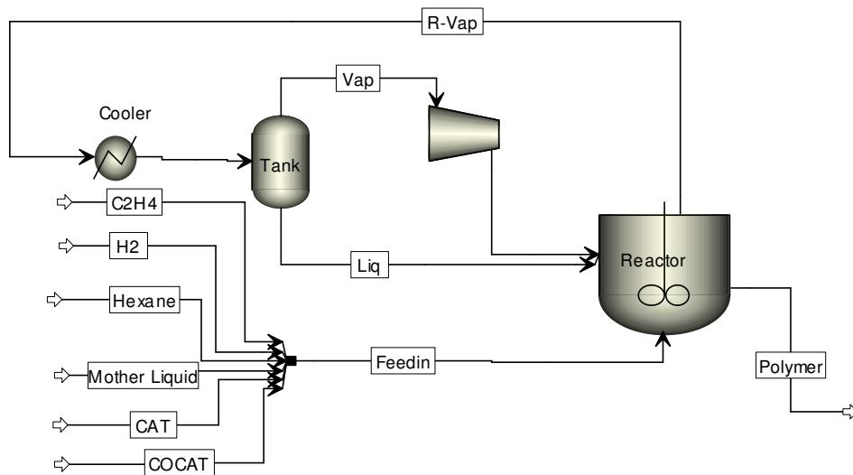
图8.4 淹浆法生产UHMWPE流程示意
