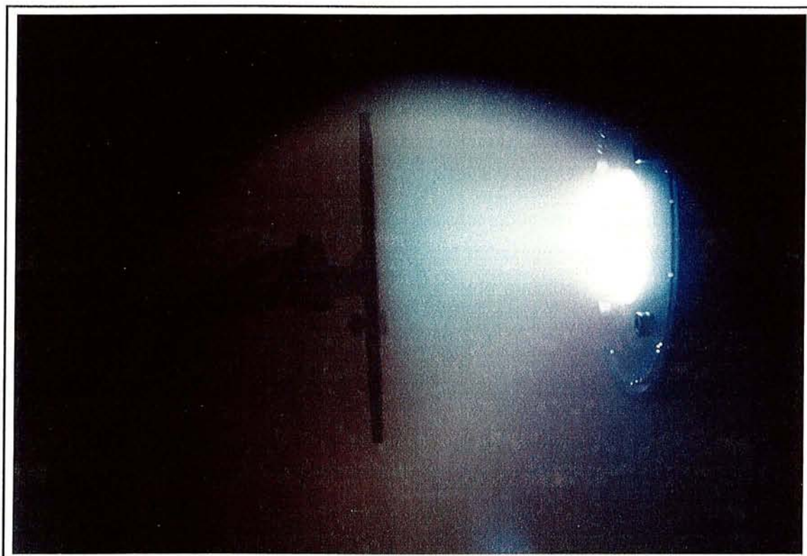
Figure IV-2 : Photographie de la décharge dans un mélange Ar-O 2 pour le point de fonctionnement correspondant au maximum d'intensité de la raie A10 (DO 2 = DO 2T1 ) après quelques minutes de pulvérisation.
