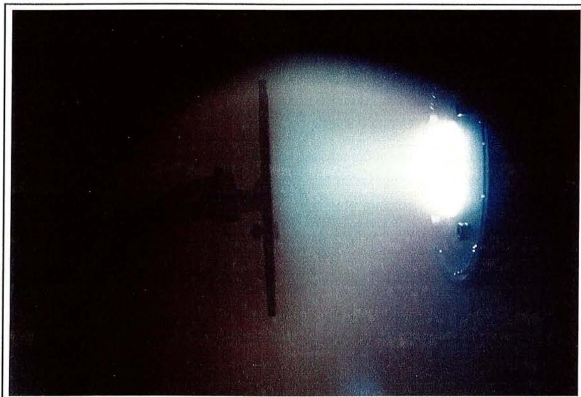
*Figure IV-2 : Photographie de la décharge dans un mélange Ar-O<sub>2</sub> pour le point de fonctionnement correspondant au maximum d'intensité de la raie A10 (DO<sub>2</sub> = DO<sub>2T1</sub>) après quelques minutes de pulvérisation.*
