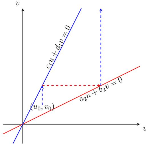
FIGURE 2.2: La variété lente associée à (2.44) et celle associée à (2.45) sont représentées respectivement en bleu et en rouge pour  $\frac{|c_1 b_2|}{|d_1 a_2|} > 1$ . Les trajectoires du système à commutation sont représentées en lignes discontinues pour une condition initiale  $(u_0, v_0)$  quand  $\varepsilon \rightarrow 0$ .
