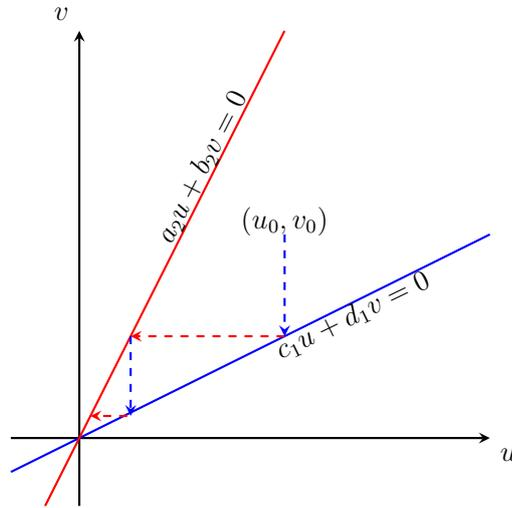
FIGURE 2.1: La variété lente associée à (2.44) et celle associée à (2.45) sont représentées respectivement en bleu et en rouge pour  $\frac{|c_1 b_2|}{|d_1 a_2|} < 1$ . Les trajectoires du système à commutation sont représentées en lignes discontinues pour une condition initiale  $(u_0, v_0)$  quand  $\varepsilon \rightarrow 0$ .
