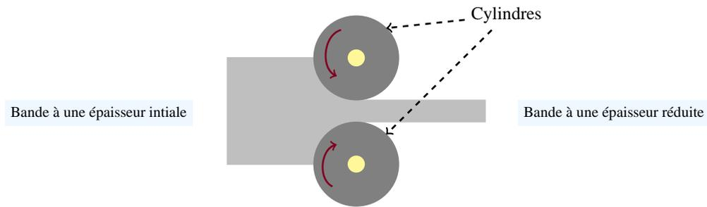
FIGURE 2: Principe du laminage : le métal subit une réduction d'épaisseur par écrasement entre les deux cylindres.
