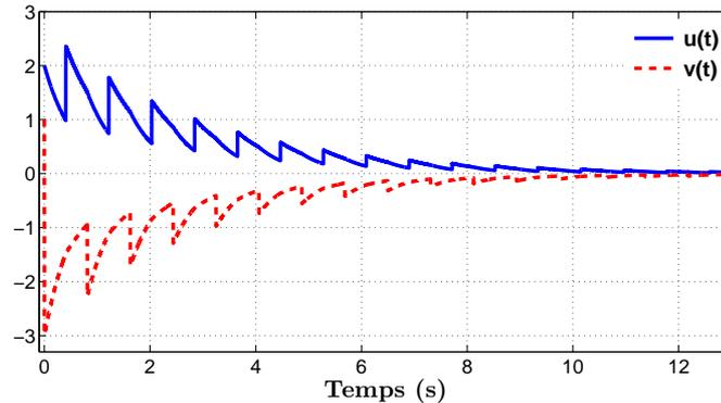
FIGURE 2.7: Trajectoires des dynamiques (2.44)-(2.45) avec  $t_{k+1} - t_k = \tau = 0.406 \text{ sec}$
