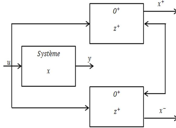
FIGURE 2.5 – Structure de l'observateur par intervalles
