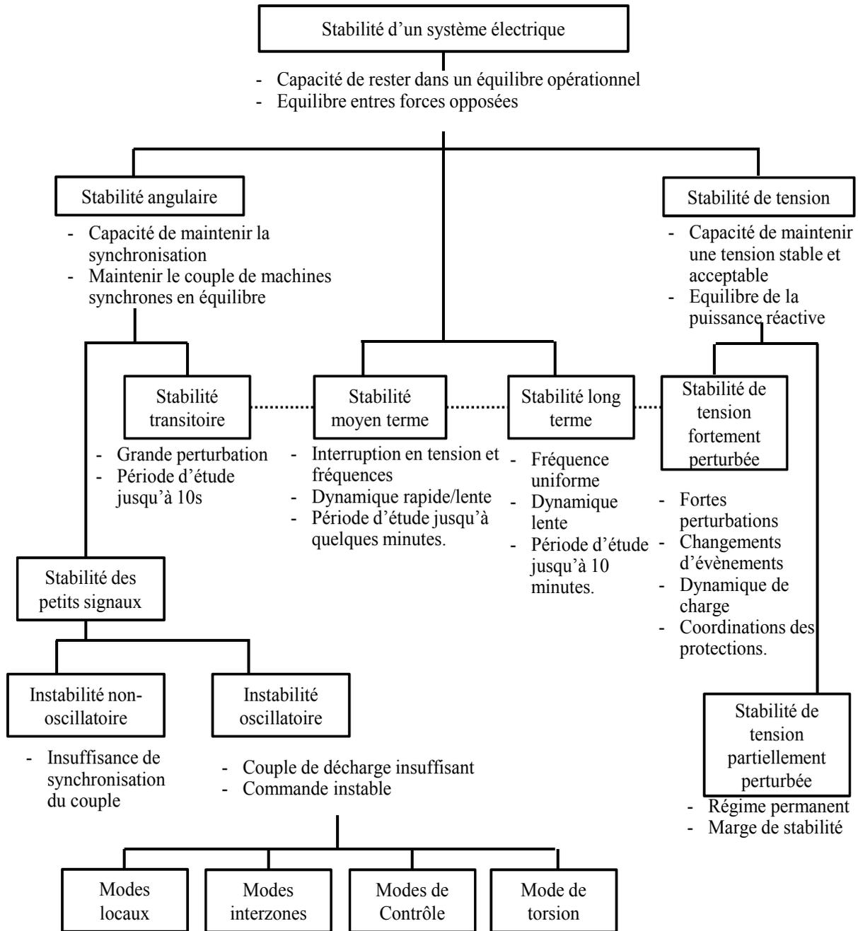
FIGURE 1.5 – Problème de stabilité d'un système électrique
