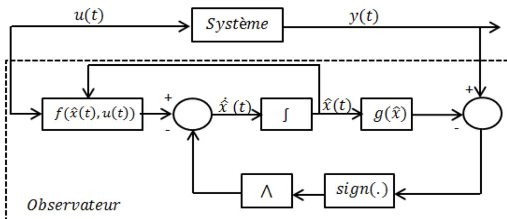
FIGURE 2.4 – Structure d'un observateur à mode glissant
