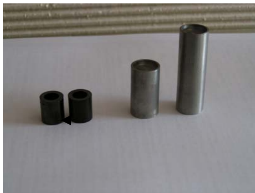
Photo A.2 : Creusets en en carbone vitreux et en molybdène.
