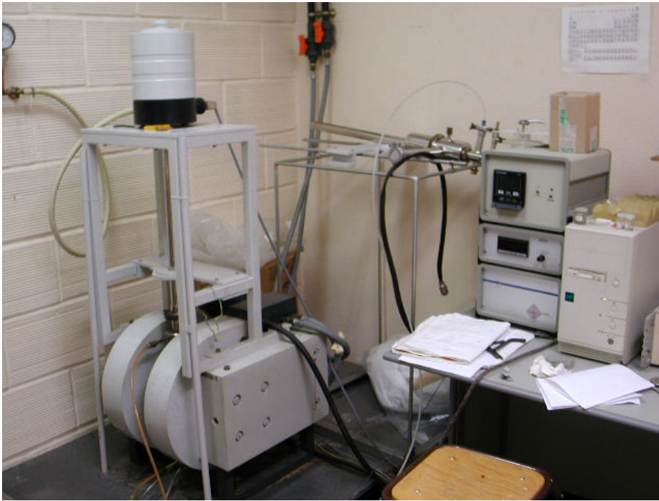
Photo A.5. : Magnéto-susceptomètre DSM8 (Laboratoire de Chimie du Solide Minéral - Nancy).
