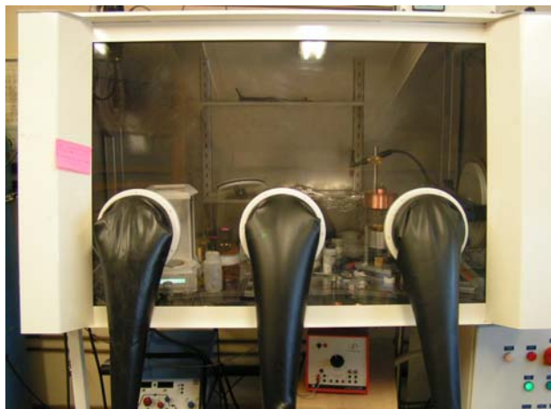
Photo A.1 : Boîte à gants de haute pureté, équipée d'un système à sceller les creusets en métal réfractaire (Ex : Mo, W, Ta).
