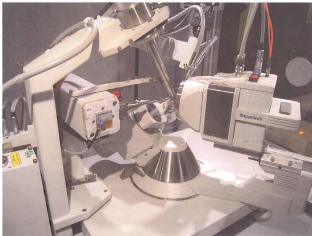
Figure 10. Le diffractomètre automatique 4 cercles Xcalibur2 Oxford Diffraction.
