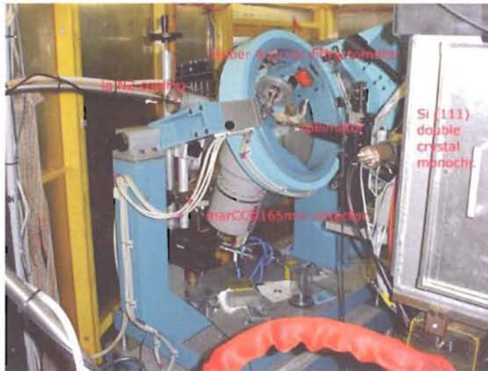
Figure 11. Le diffractomètre à 4 cercles Huber sur la ligne D3 (Hasylab-Hambourg)
