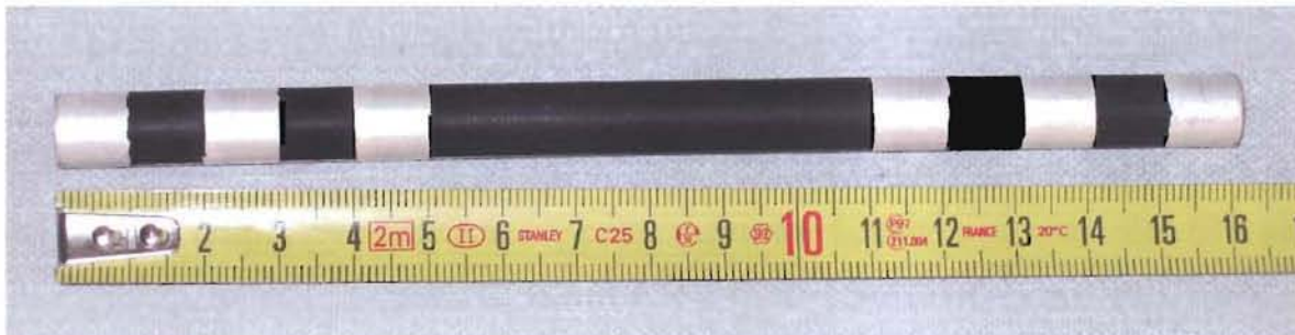
Figure 3.1 : Photo de l'amenée de courant \text{Bi}_{1.8}\text{Pb}_{0.26}\text{Sr}_2\text{Ca}_2\text{Cu}_3\text{O}_{10-x} étudiée.
