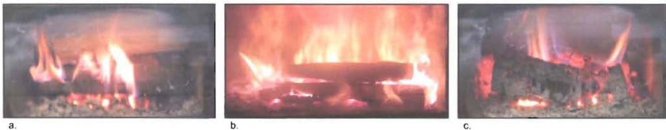
Figure 88 Étapes de la combustion a- Allumage, b- Combustion vive, c- Combustion hétérogène
