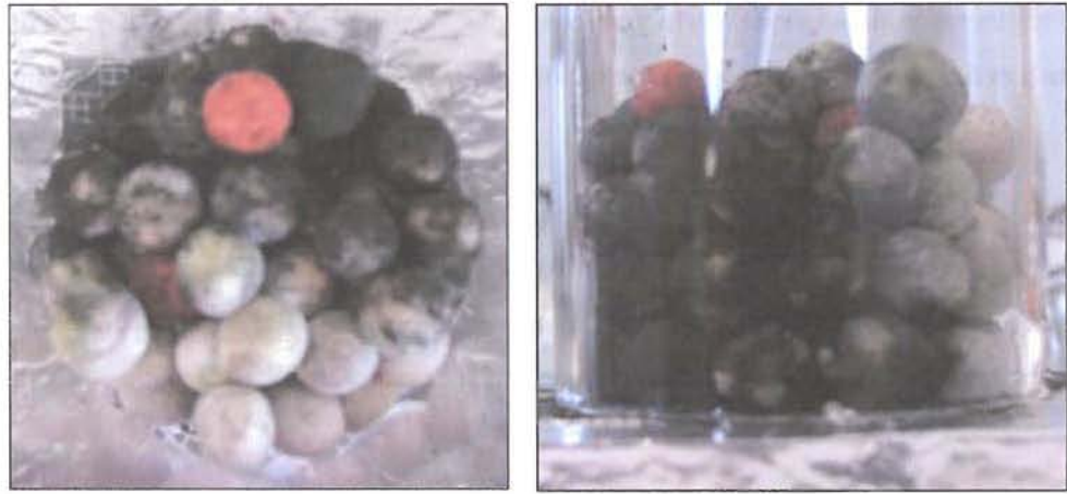
Figure 73 Lit de billes après régénération lorsque le filtre est en aval de l'entrée des micro-ondes
