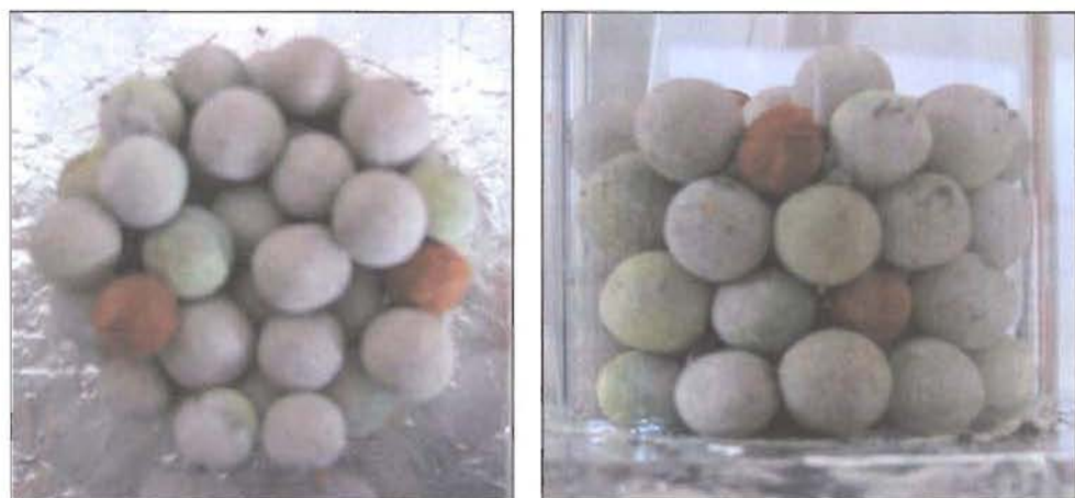
Figure 75 Lit de billes après régénération lorsque le filtre est en amont de l'entrée des micro-ondes
