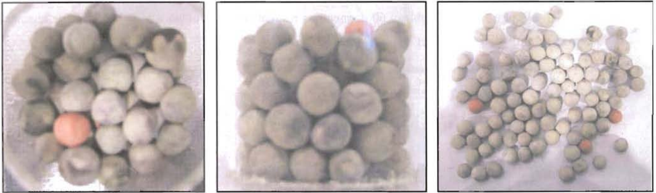
Figure 149 : Exemple de billes complètement régénérées avec 200 mA pendant 10 min
