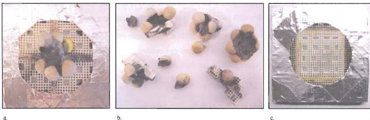
Figure 76 : Grille avec le joint au milieu (a) – Grille et billes fondues (b) – Grille avec les joints sur les côtés (c)
