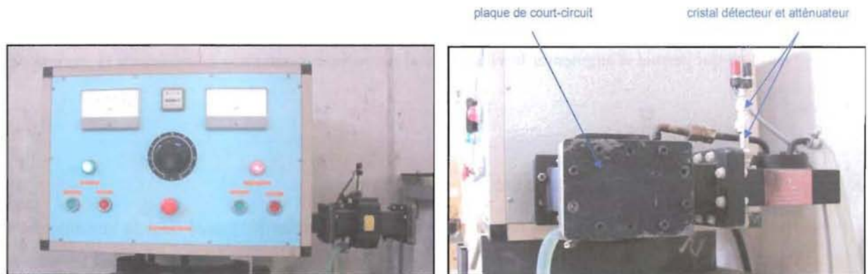
Figure 82 : Montage d'étalonnage du cristal détecteur
