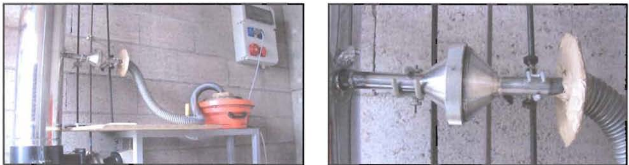
Figure 50 Dispositif de prélèvement de poussières
