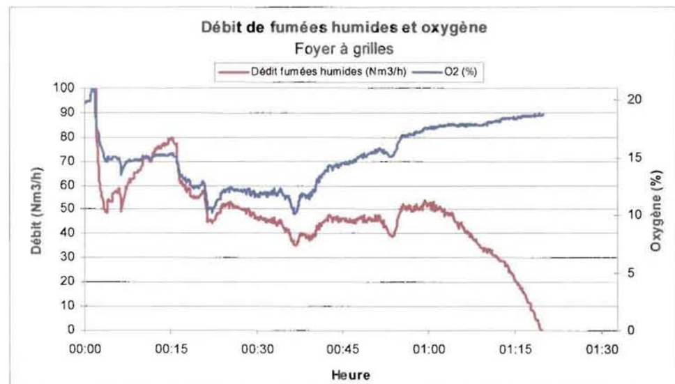
Figure 99 : Courbe type du débit de fumées humides et O 2
