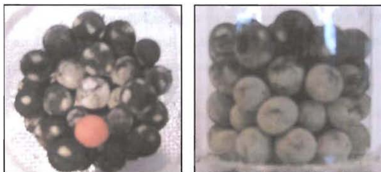
Figure 153 : Exemple de billes partiellement nettoyées sous 200 mA pendant 10 min
