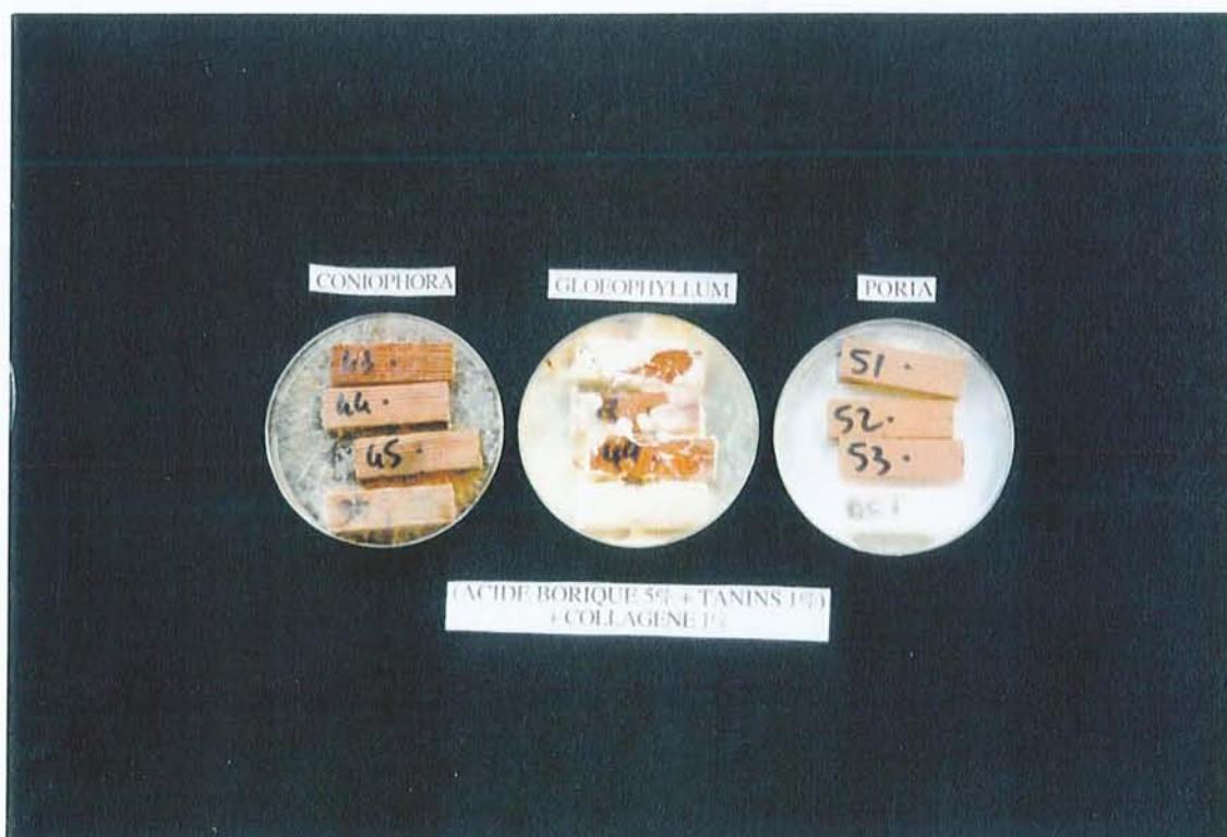
Figure 50. Aspect des éprouvettes traitées avec le mélange borate de gélatine-tanins et lessivées, à la fin des 4 semaines d'exposition aux champignons Basidiomycètes cultivés en boîtes de Pétri. Les éprouvettes témoins (1 par boîte) sont entièrement recouvertes de mycélium.
