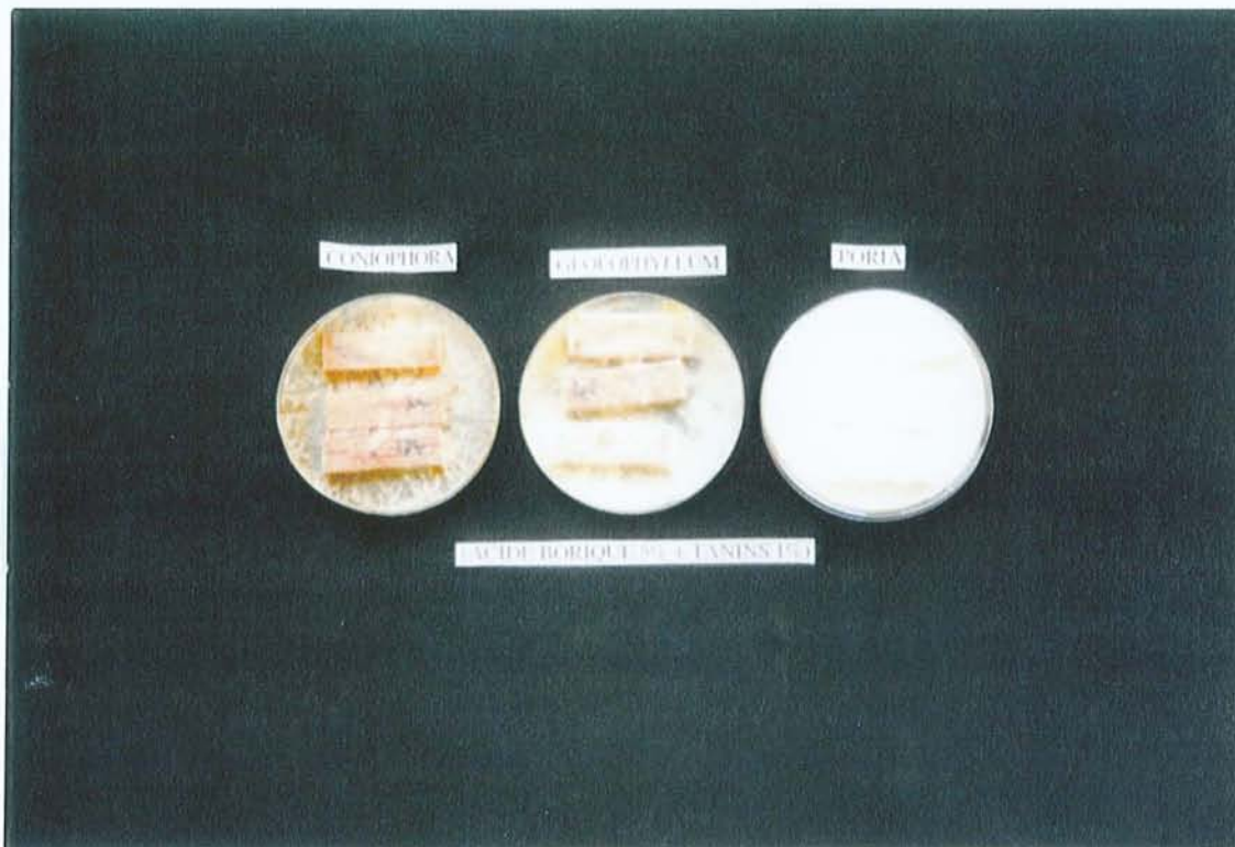
Figure 49. Aspect des éprouvettes traitées avec le mélange acide borique-tanins et lessivées, à la fin des 4 semaines d'exposition aux Basidiomycètes cultivés en boîtes de Pétri.
