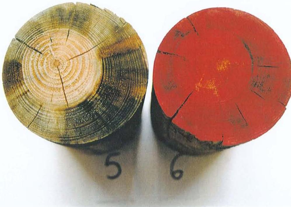
Figure 57. Photographie de sections de poteau traité au borate d'albumine. La coloration rose met en évidence le bore (section de droite), et la coloration bleue reflète la présence de protéines (section de gauche).
