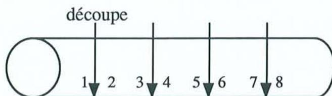
Figure 22. Schéma de la découpe d'un poteau et numérotation des pièces de bois obtenues.
