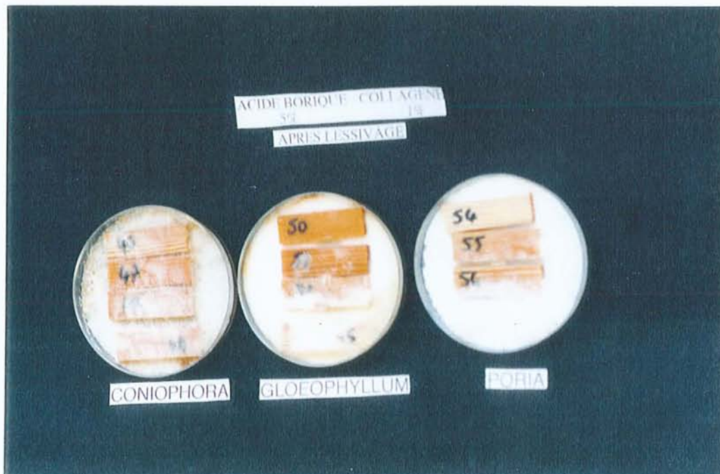
Figure 44. Aspect des éprouvettes traitées au borate de gélatine et lessivées, à la fin des 4 semaines d'exposition aux champignons Basidiomycètes cultivés en boîtes de Pétri. Les éprouvettes témoins sont entièrement recouvertes de mycélium.
