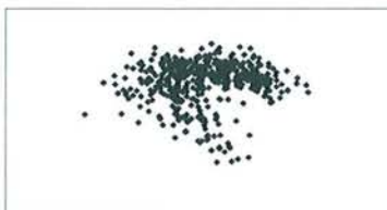
Fig. 5.12e : Attracteur, image spatio-temporelle et section de Poincaré après contrôle pour les deux retards.
