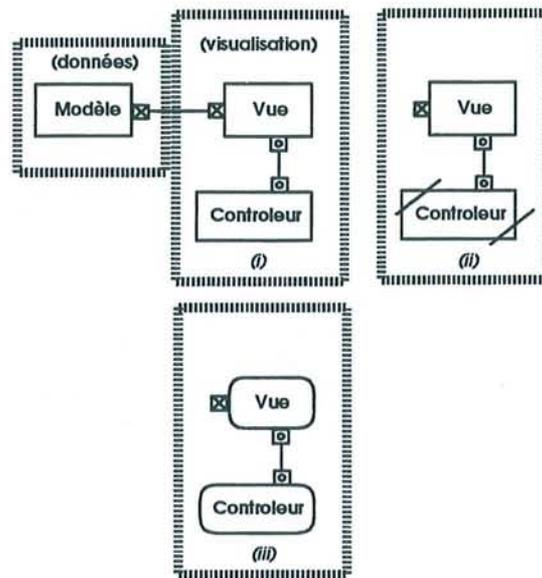
FIG. 10.2 – Architecture et adaptabilité du modèle MVC
