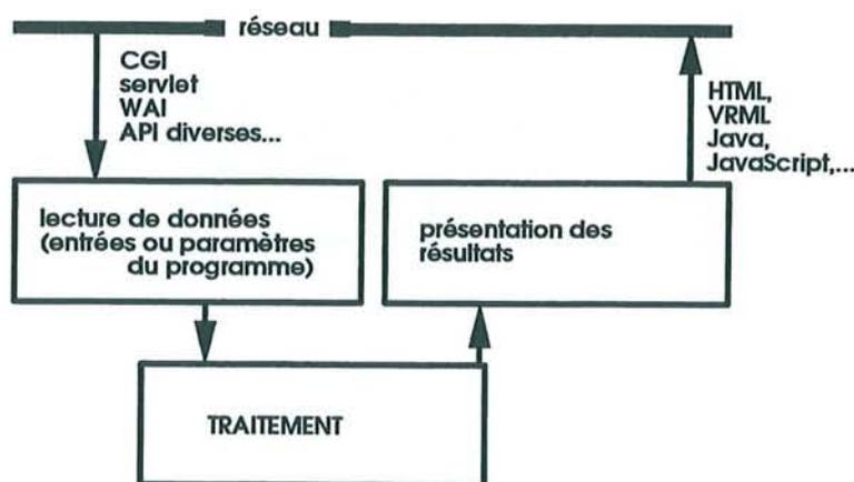
FIG. 2.5 – Architecture schématique d'un service WWW dynamique
