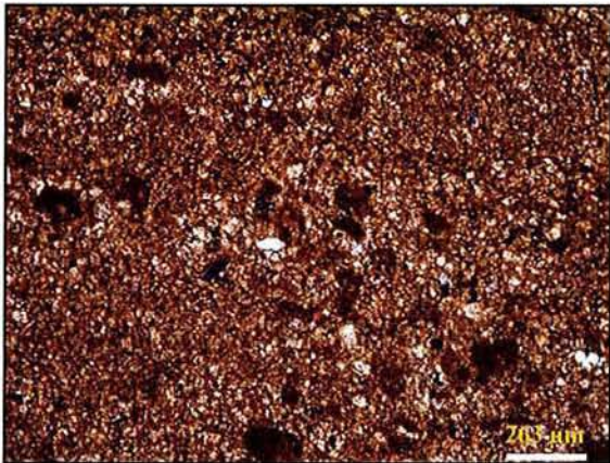
Fig. 2.13 a : dolomie vacuolaire micritique à pellets. Couche inférieure (MM2)
