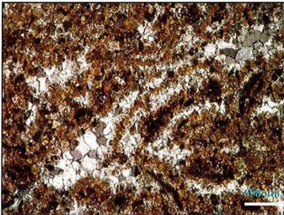
Fig. 2.15 a : dolomie packstone à grainstone Palier inférieur (MO1, Unité C)
