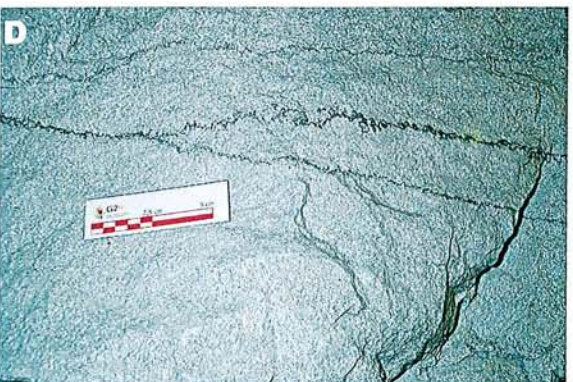
Figure 14 : Photographies dans le puits principal, site Meuse/H te -Marne, volée 1078, cote 175,15m ; A et B vues générales de la paroi, C et D détails ; deux générations de joints stylolitiques stratiformes : stylolite 1 lié à la compaction initiale des sédiments et parallèles aux stratifications obliques ; stylolite 2 subhorizontal associé aux réactivations tectoniques extensives ; une génération de joints verticaux : stylolite 3 liés à la compression alpine avec les pics horizontaux orientés NW-SE.
