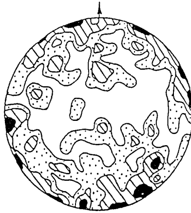
Figure 56: fracturation (plans de diaclases) autour du gisement des Bondons. Canevas de schmidt, hémisphère inférieure, 134 mesures, coupures: 0.5, 1.5, 3.5, max 5%.
