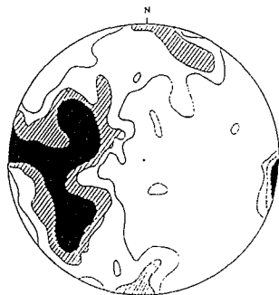
Figure 5: Répartition des foliations magmatiques dans le granite de Saint Sylvestre. 513 mesures, coupures à 2.5, 4.5 et 7.5%. Canevas de Schmidt, hémisphère inférieur (Girard, 1990).
