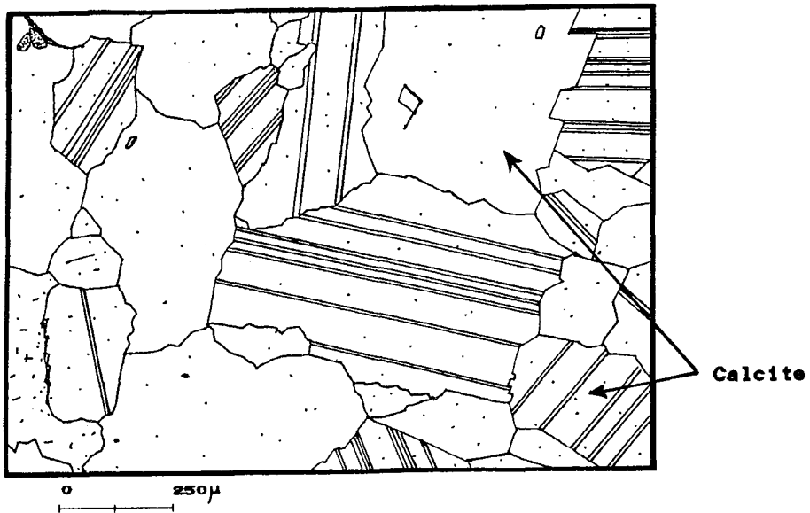
Fig.31.- Aspect du marbre de substitution du site n°19, aux contacts entre cristaux de calcite nets.
