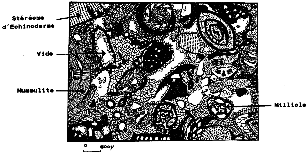
Fig.20.- Calcaire de la Pyramide de Khéops : faciès bioclastique ( grainstone ), riche en foraminifères benthiques (miliolles, nummulites). La très forte porosité résulte de la dissolution du ciment de calcite spathique.
