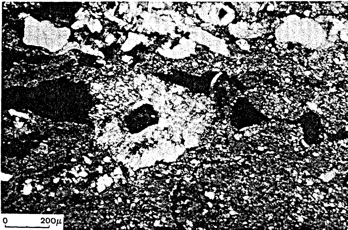
Photo 2.- Pyrite entourée de gypse micro-cristallin résultant de son oxydation (molasse du Bourget)(lumière polarisée).
