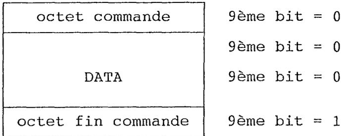
figure 34 : Format d'une requête ou d'une indication
