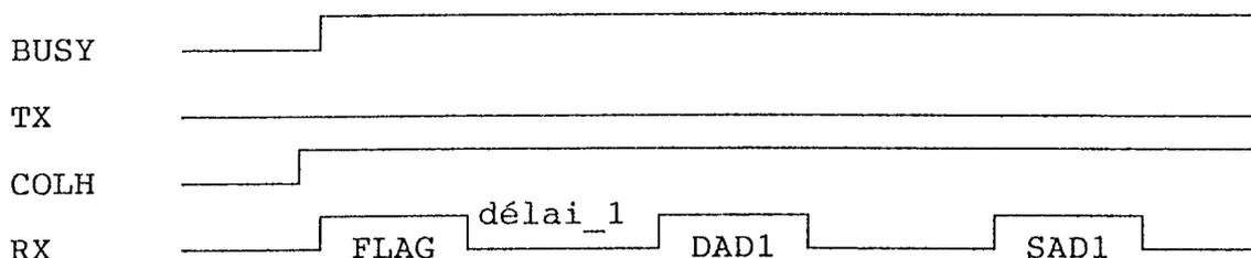
figure 17 : émission avec un écart de moins de 3 microsecondes et plus de 125 nanosecondes
