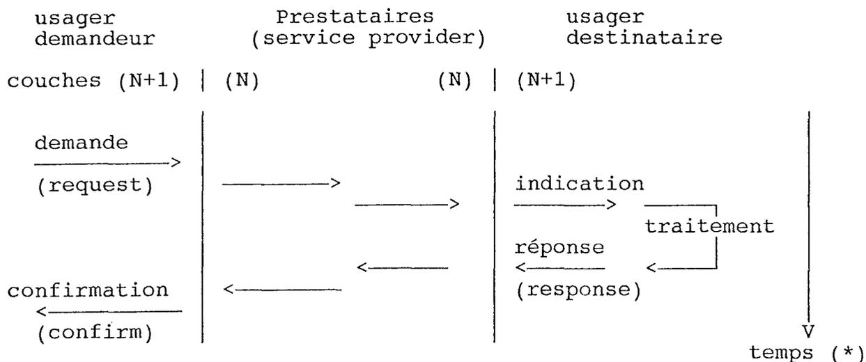
figure 15 : cycle élémentaire d'un service OSI
