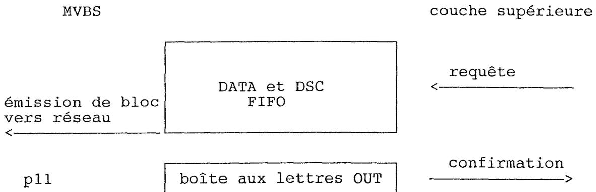
figure 35 : cinématique dans le fifo du 80C452 en transmission
