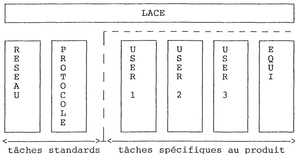
figure 6 : structure logicielle d'un communicateur LAC
