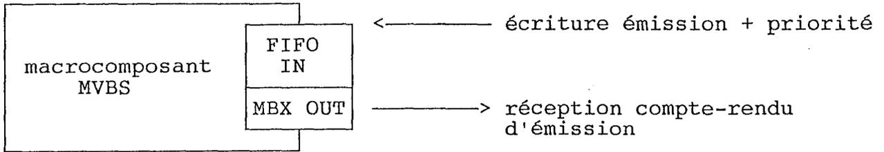
figure 17 : interfaçage du MVBS-hôte lors d'une émission
