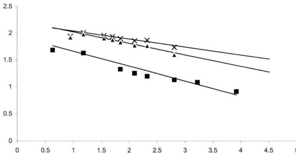
Figure 3.10 : Données expérimentales (avec  $\sqrt{\Delta}$  en abscisse et  $(1 - S(\Delta)/S_0)/e^{-\Delta/T_1}$  en ordonnée) et droites de régression linéaire correspondantes. Croix : éthanol ; triangles : eau ; carrés : acétone. Les paramètres expérimentaux sont les mêmes que pour la Figure 3.9.
