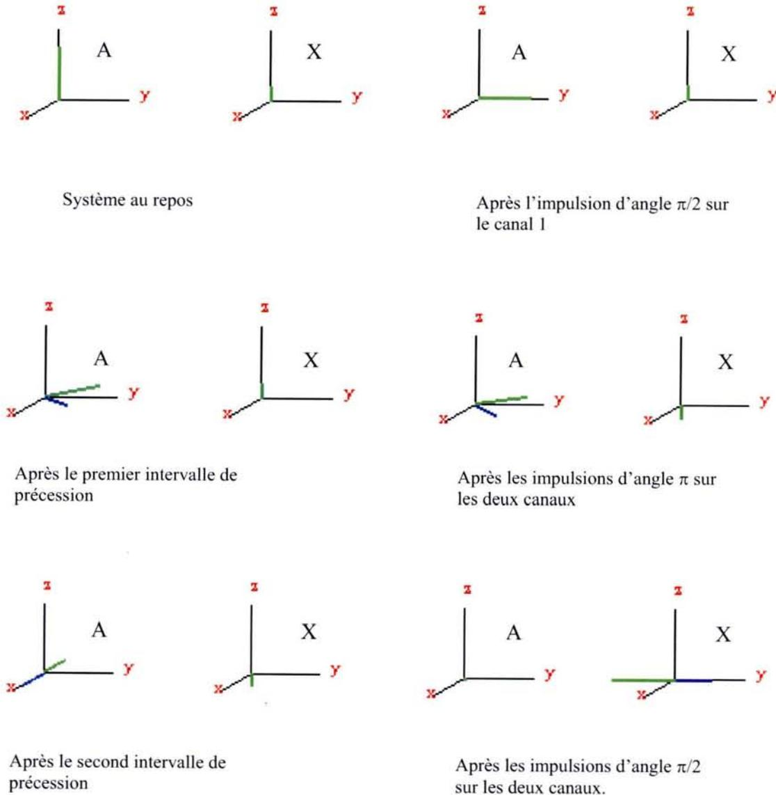
Figure 1.12 : Visualisation de l'évolution des aimantations A et X (proton et carbone 13 respectivement) lors du déroulement d'une séquence INEPT. Les deux composantes du doublet du carbone 13 sont représentées respectivement par des segments de couleur bleue et verte.
