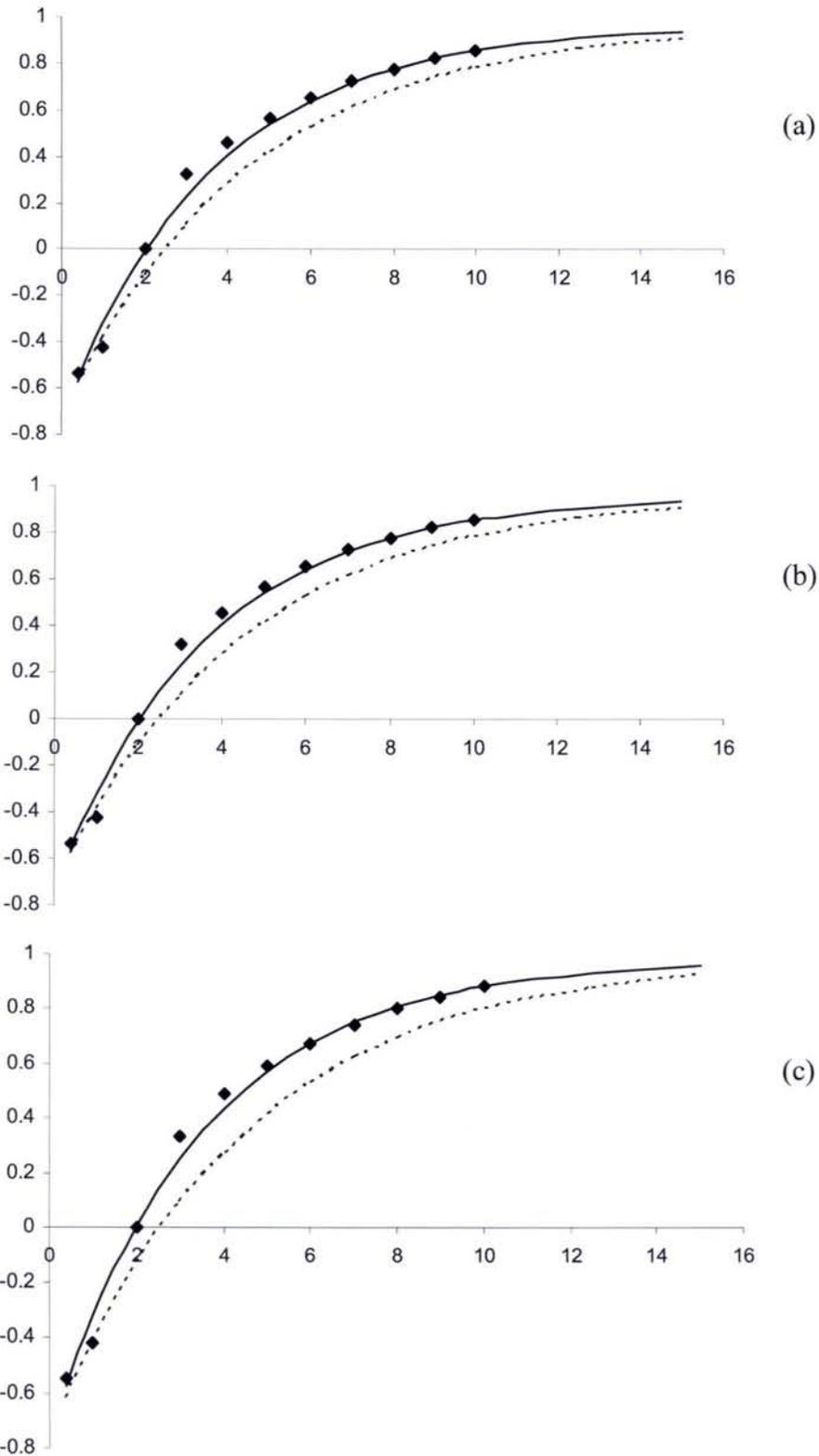
Figure 3.12 : Courbes d'inversion récupération pour un échantillon d'eau avec 3 largeurs de sélection de tranche différentes :  $800\mu\text{m}$ ,  $450\mu\text{m}$ ,  $300\mu\text{m}$  (température de l'échantillon :  $25^\circ\text{C}$ ). En pointillé: courbe de relaxation avec détection sélective, mais sans inversion sélective. En trait plein, la courbe de relaxation ajustée sur les point expérimentaux. Ces expériences ont été réalisées par le docteur J.M. Escanyé.
