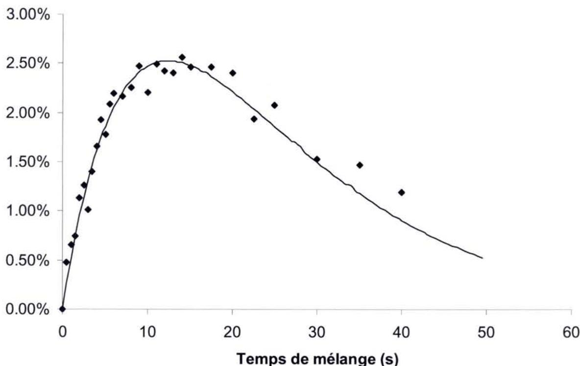
Figure 1.21 : Intensité de l'ordre longitudinal en fonction du temps de mélange. Points : données expérimentales. Trait : simulation, avec  $R_1^H = 0.14s^{-1}$ ,  $R_1^C = 0.09s^{-1}$ ,  $R_{1CH} = 0.09s^{-1}$ ,  $\sigma_{CH} = 0.029s^{-1}$  et  $\sigma_{CSA(C)-d} = 0.009s^{-1}$
