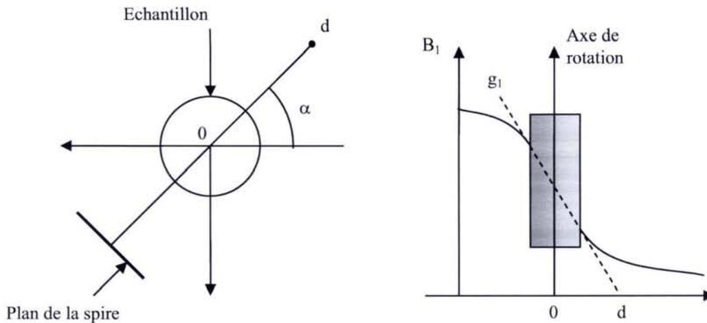
Figure 2.7 : Principe de l'imagerie bidimensionnelle par gradient de champ radiofréquence. Définition de l'angle de rotation  $\alpha$  et de  $d$ , point virtuel où le champ  $B_1$  créé par la spire serait nul.
