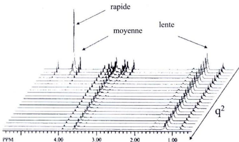
Figure 3.5 : Série de spectres<sup>12</sup> obtenus à l'aide d'une expérience de mesure de diffusion par gradient de champ radiofréquence en incrémentant la durée des impulsions de gradient. L'expérience porte sur un mélange de sucrose, sulfate de sodium dodecyle et hexaéthylène glycol dodecyle ether (0.1M chaque) dans D<sub>2</sub>O. On discerne bien trois type de diffusion : rapide, moyenne et lente.
