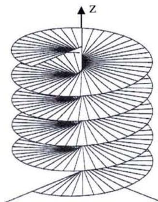
Figure 1.9 : Représentation, en fonction de la position selon l'axe du gradient, de l'effet d'une impulsion de gradient de champ statique  $B_0$ . Chaque trait correspond à la position de l'aimantation dans une tranche donnée.
