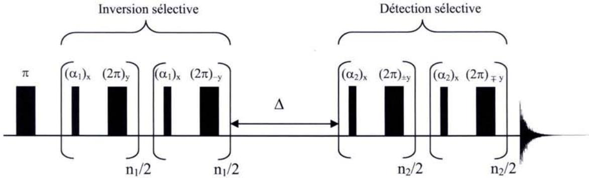
Figure 3.13 : Séquence de mesure du coefficient d'auto-diffusion par inversion de l'aimantation sauf dans tranche fine.  $n_1$  et  $n_2$  sont choisis de sorte que les tranches sélectionnées pour l'inversion et la détection soient de même largeur.
