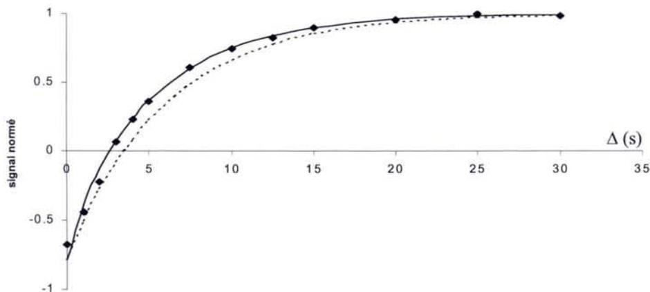
Figure 3.9 : Courbes d'inversion - récupération pour un échantillon 50%  $H_2O$ , 50%  $D_2O$  à 25°C. En pointillé une courbe de relaxation avec détection sélective, mais sans inversion sélective. En trait plein, la courbe correspondant à la séquence représentée dans la Figure 3.7. Dans cette expérience,  $n_1 = 30$  et  $n_2 = 40$ , ce qui correspond, pour la sonde utilisée, à une tranche sélectionnée de 700  $\mu m$ .
