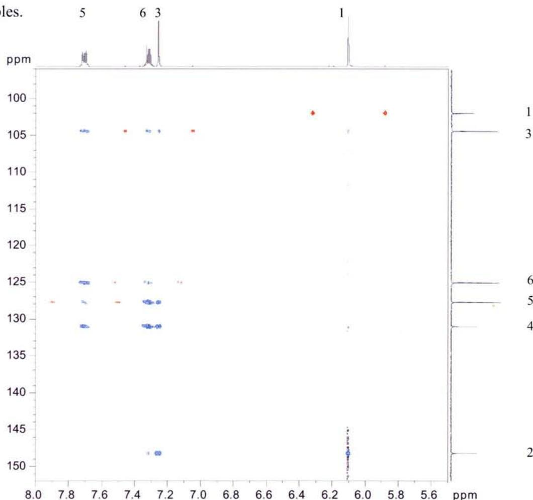
Figure 1.29 : Spectre 2D du nd11 pour une expérience HMBC  $^1\text{H}$ - $^{13}\text{C}$  effectuée sur un spectromètre 9.4T (fréquence de résonance de  $^1\text{H}$  : 400MHz). 8 expériences ont été accumulées. En rouge sont représentés les couplages directs (1 liaison) et en bleu les couplages à longue distance (plusieurs liaisons).
