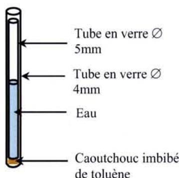
Figure 2.27 : Dispositif expérimental
