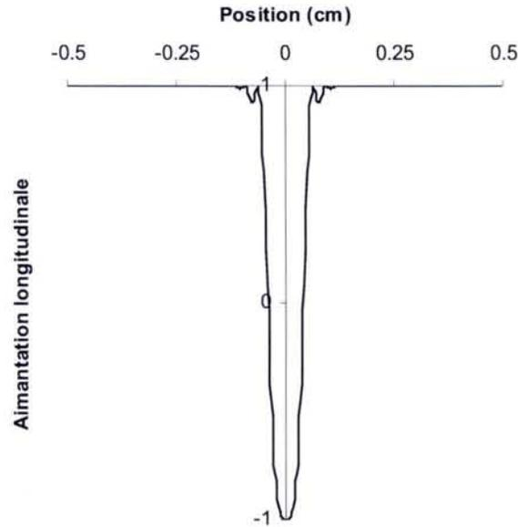
Figure 3.8 : Simulation du profil d'inversion, avec  $n_I=64$ . Le profil du champ  $B_1$  a été assimilé à une fonction gaussienne ajustée sur le profil expérimental du champ délivré par une bobine de 2mm de hauteur. L'aimantation transversale est nulle.
