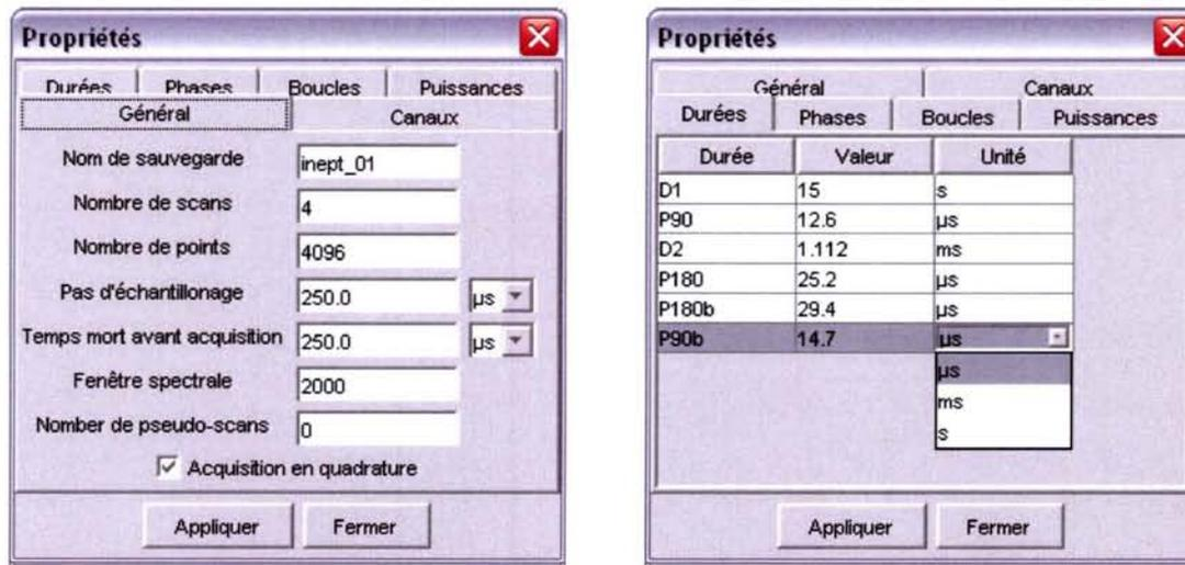
Figure 1.4 : Exemple de fenêtres de saisie des paramètres
