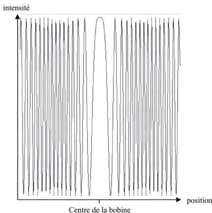
Figure 2.3 : Intensité de la composante longitudinale de l'aimantation après l'application de 50 impulsions consécutives, l'angle de basculement étant de  $2\pi$  au centre de la bobine en selle de cheval.
