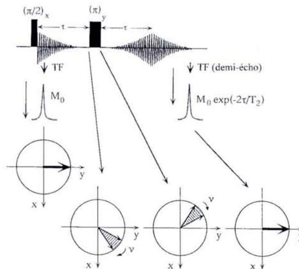
Figure 3.1 : La séquence d'écho de Hahn, qui permet la refocalisation de toute précession due soit à l'effet du déplacement chimique, soit à l'inhomogénéité du champ statique  $B_0$ . Les zones hachurées représentent l'étalement des fréquences de précession due à l'inhomogénéité de  $B_0$ ; elles ont été réduites pour favoriser la visualisation du phénomène d'écho.
