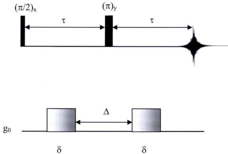
Figure 3.2 : Séquence d'écho avec impulsions de gradient de champ statique (où PGSE). Les impulsions ont une durée  $\delta$  et sont placées de part et d'autre de l'impulsion d'angle  $\pi$ . On procède généralement par incrément de l'amplitude du gradient.
