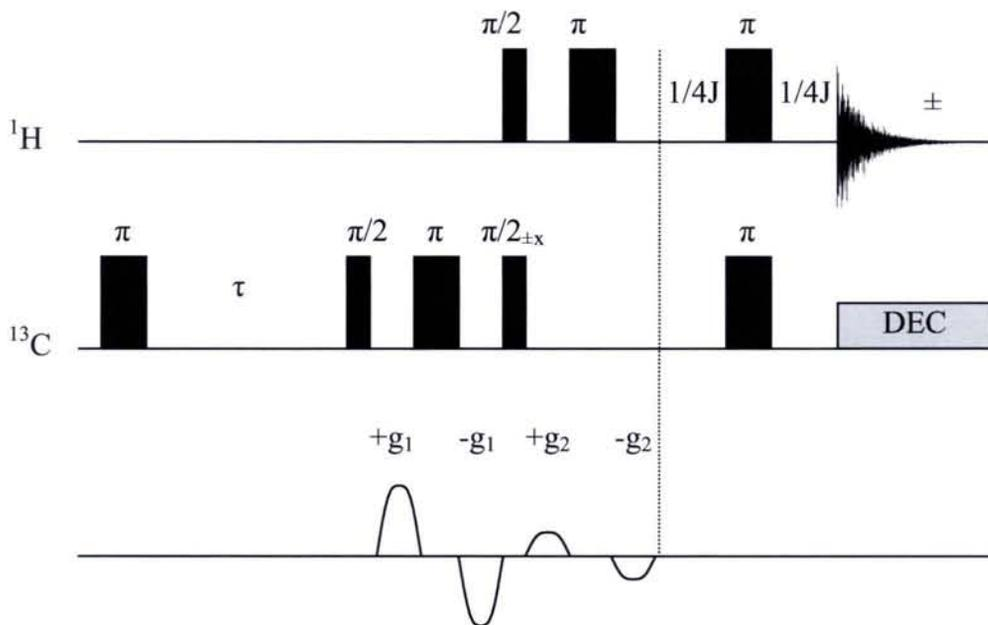
Figure 1.24 : Séquence complète de filtrage de l'ordre longitudinal par l'utilisation d'impulsions de gradients de champ statique. La partie située à droite du pointillé est une procédure optionnelle de refocalisation du doublet, suivie d'un découplage pendant l'acquisition.
