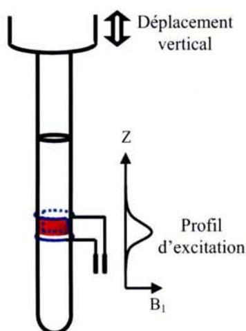
Figure 2.21 : Principe de l'expérience
