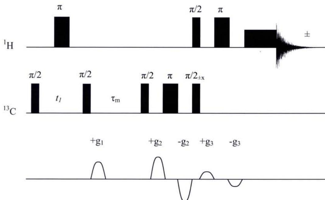
Figure 1.27 : Version à deux dimensions de la séquence impulsionnelle. Les puissances des gradients  $g_2$  et  $g_3$  sont choisies de la même manière que dans l'expérience précédente. L'acquisition du signal est précédée d'une impulsion de longue durée et de faible puissance afin d'éliminer d'éventuelles composantes indésirables.
