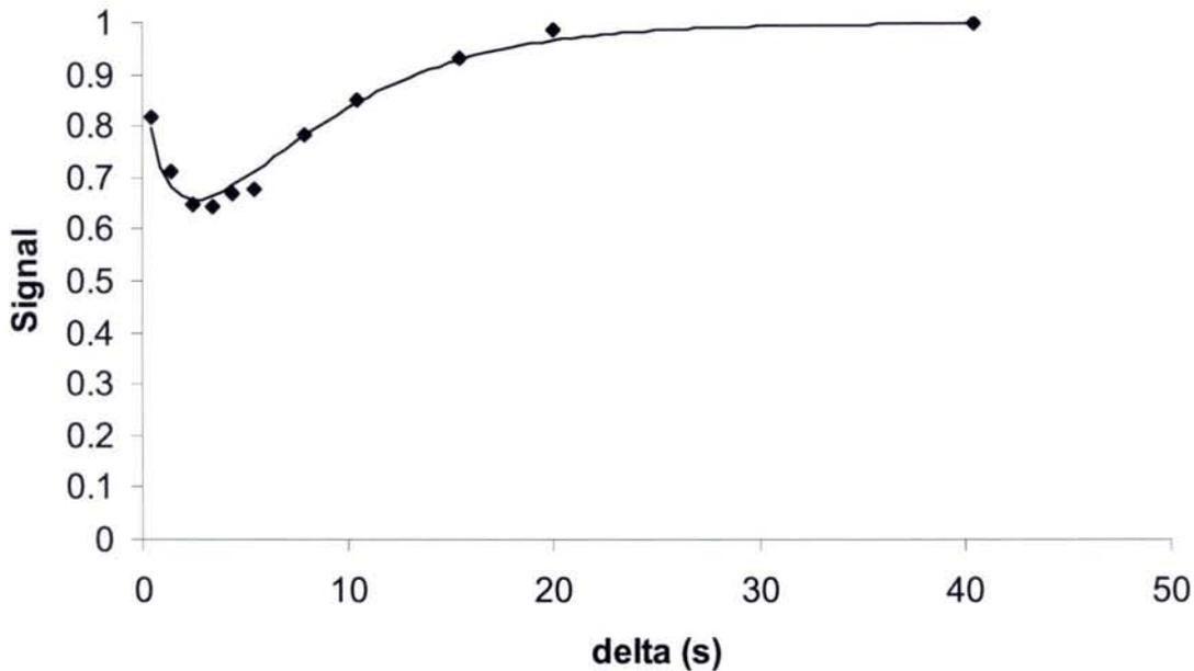
Figure 3.14 : Courbe représentant le signal en fonction de la durée de l'intervalle de diffusion  $\Delta$  pour un échantillon d'acétone à 25°C. Les points représentent les valeurs expérimentales. En trait plein : courbe théorique (voir l'équation (3.38)) obtenue en calculant les différentes grandeurs par régression linéaire (équation (3.39) et (3.40))
