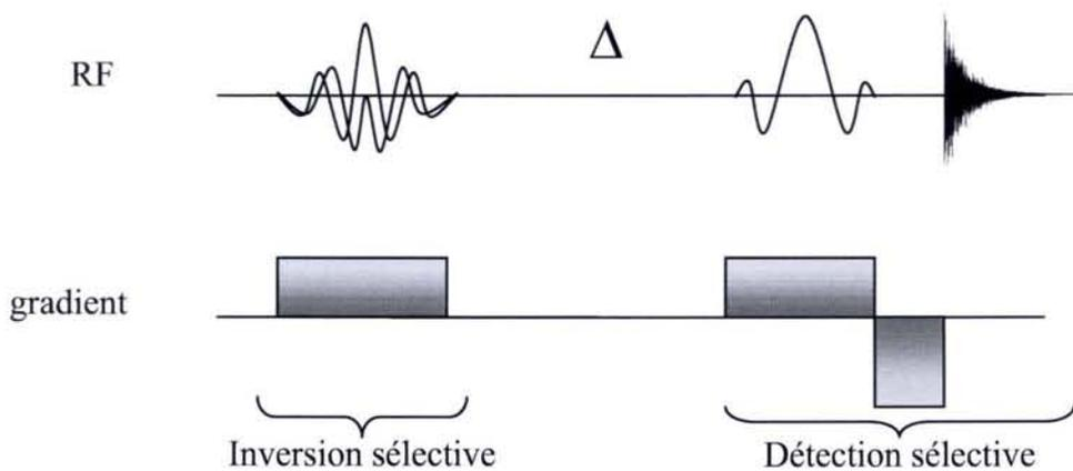
Figure 3.11 : Séquence de mesure de coefficient de diffusion par sélection de tranche utilisant des gradients de champ statique. L'impulsion sélective d'inversion est en forme de sécante hyperbolique (correspondant à deux formes d'impulsions appliquées simultanément le long des axes x et y). L'impulsion sélective de détection est en forme de sinus cardinal.
