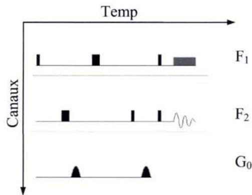
Figure 1.6 : représentation d'une séquence par un diagramme temps/canal
