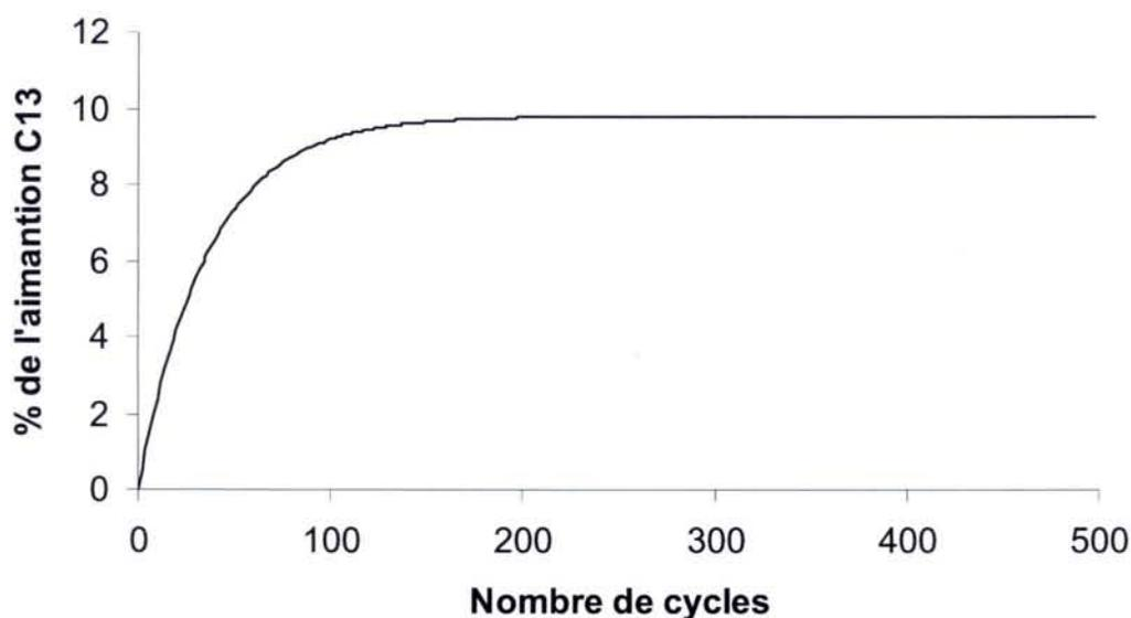
Figure 1.16 : Simulation de l'évolution de l'aimantation de l'ordre longitudinal en fonction du nombre d'impulsions (expérience de la Figure 1.13 en supposant des champs radiofréquence parfaitement homogènes)
