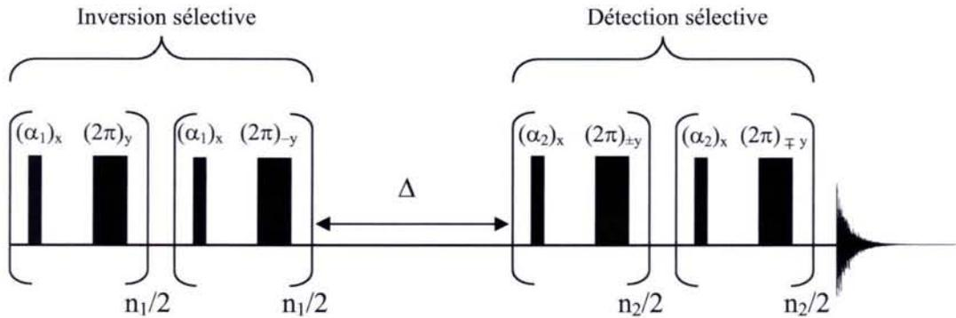
Figure 3.7 : Séquence de mesure de diffusion par sélection de tranche utilisant l'inhomogénéité naturelle du champ radiofréquence. On a  $n_1 \times \alpha_1 = \pi$  et  $n_2 \times \alpha_2 = \pi/2$ . On notera que pour obtenir une sélection de tranche équivalente pour l'inversion et la détection,  $n_2$  doit être supérieur à  $n_1$ .
