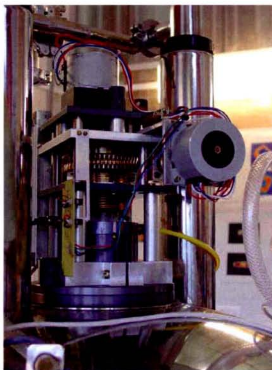
Figure 2.22 : Dispositif de déplacement vertical de l'échantillon installé sur la partie supérieure d'un aimant vertical à large ouverture (« wide bore », 89mm de diamètre) délivrant un champ de 4.7T. Au premier plan, le moteur pas-à-pas relié à la vis sans fin
