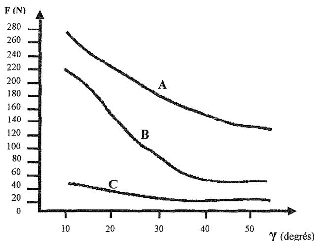
Figure II.17 Influence de l'angle d'attaque sur les efforts de coupe suivant les directions de coupe A, B, C (voir figure II.1) pour le hêtre (à 12% d'humidité, copeau de 0,2 mm d'épaisseur, outil usé à 50%) (d'après la thèse de Eyma, 2002)
