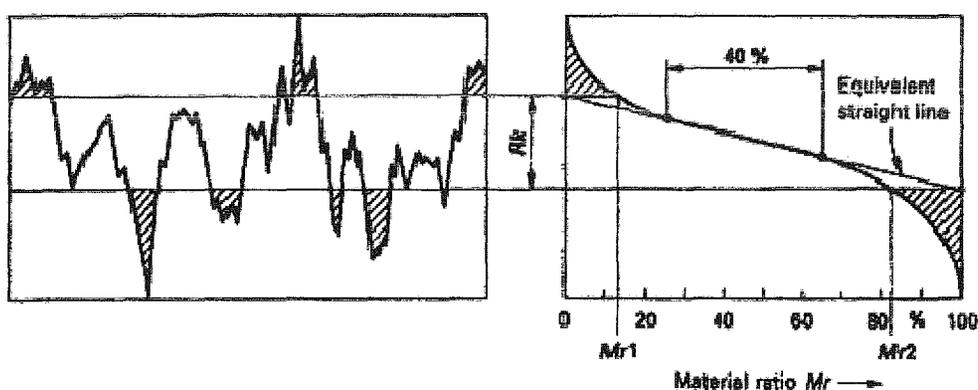
Figure II.51 Définition des paramètres  $R_k$ ,  $R_{vk}$  et  $R_{pk}$  (de la figure 1 d'ISO 13565-2, 1996)
