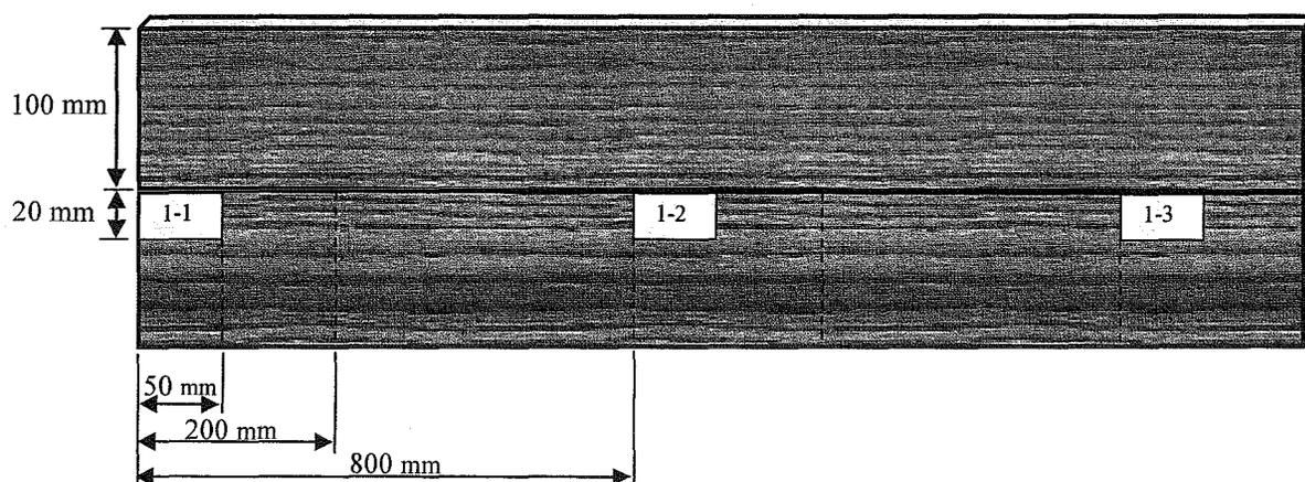
Figure III.3 Débit des éprouvettes pour les essais physico-mécaniques
