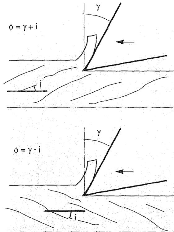
Figure II.25 Evolution de l'angle de levage  $\phi$  en fonction de l'angle de coupe  $\gamma$  et de celui d'inclination des fibres  $i$  (d'après Koch, 1964)
