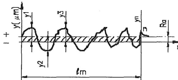
Figure II.36 Rugosité moyenne (Ra)
