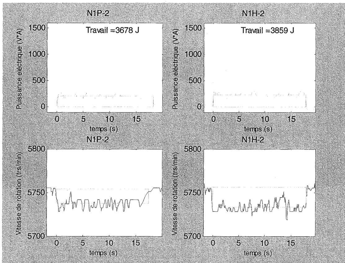
Figure IV.56 - Monitorisation d'usinage du pin et de hêtre pour le niveau 1
