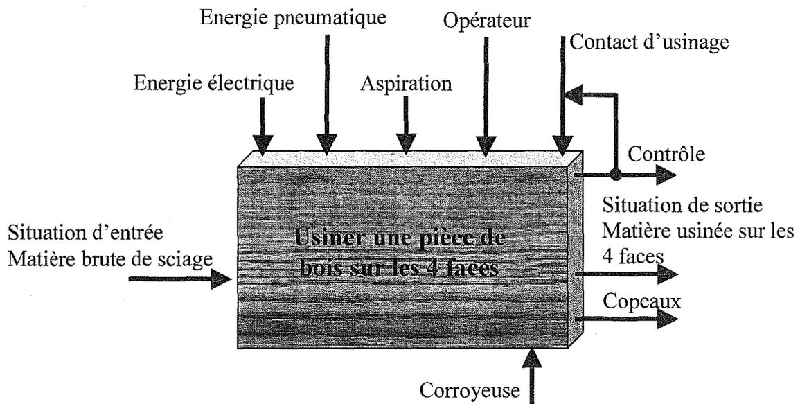
Figure II.34 L'étude fonctionnelle du système de la corroyeuse
