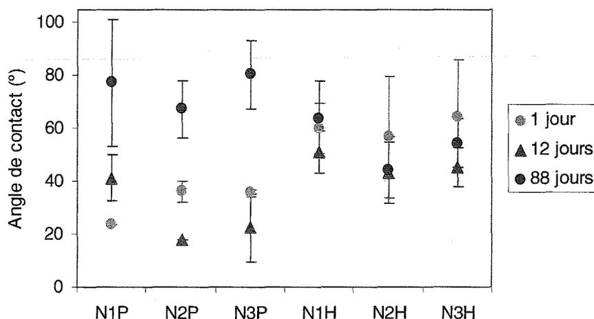
Figure IV.87 - Moyenne et écart-type de l'angle de contact pour le pin (P) et le hêtre (H) usinée avec le niveau N1, N2 et N3 (après 1, 12 et 88 jours)
