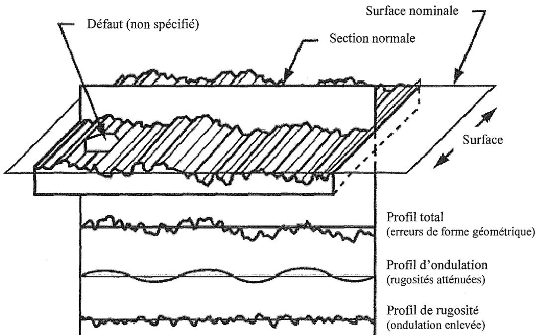
Figure II.35 Diagramme schématisé des caractéristiques de la surface (ASME B46.1, 1995)
