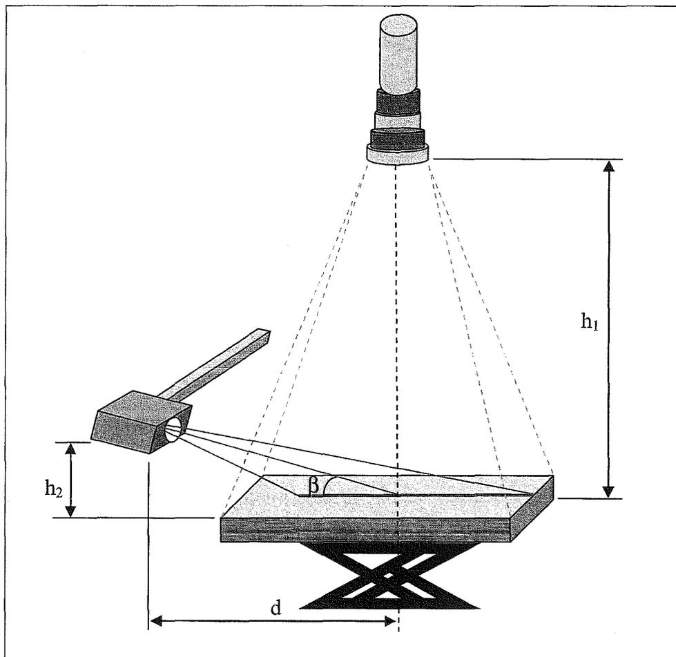
Figure III.13 Schéma du système de vision laser
