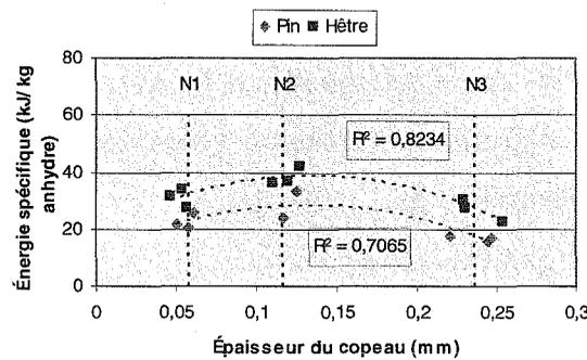
Figure IV.30 - Influence du niveau d'usinage sur l'énergie spécifique
