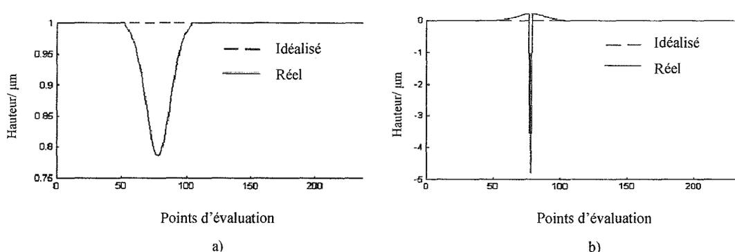
Figure II.47 a) Déformation de la ligne de référence du filtrage Gaussien; b) Déformation résiduelle après le filtrage Gaussien (adaptée de Li *et al.*, 2004)
