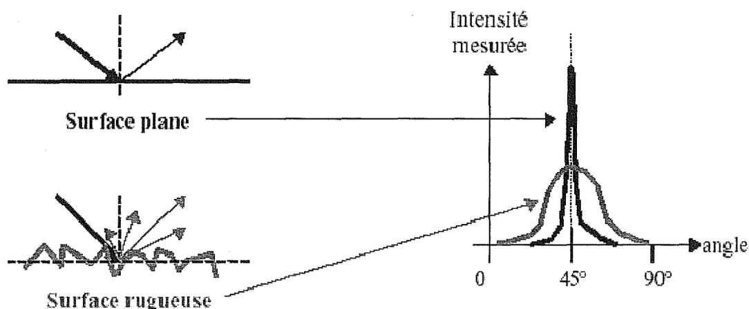
Figure II.58 Réflexion par une surface plane et par une surface rugueuse.
