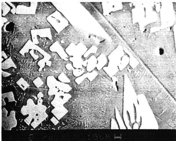
Figure IV-4 : Cliché de microscopie électronique à balayage (électrons rétrodiffusés) d'un alliage de composition \text{Ru}_{19}\text{Ge}_{81} brut de fusion au four à induction. Nous pouvons noter la présence de phase primaire claire ( \text{Ru}_2\text{Ge}_3 ), de la matrice de germanium pur, ainsi que de l'eutectique.
