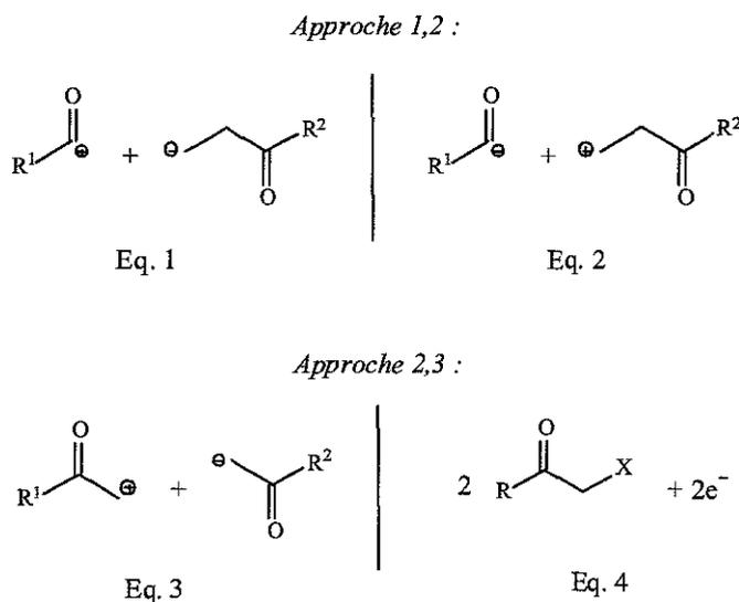
La première stratégie peut être réalisée par acylation d'anions homoénolates de cétones (Eq. 1) ou par addition conjuguée d'équivalents anioniques d'acylures sur des composés carbonylés  $\alpha,\beta$  insaturés (Eq. 2).
