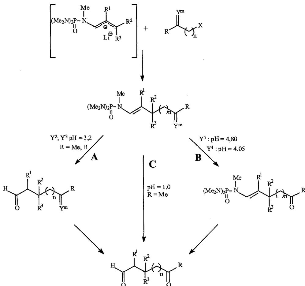
A pH=4,80 ( $Y^5$ ) ou à pH=4,05 ( $Y^4$ ) il est en revanche possible d'hydrolyser sélectivement la fonction acétal sans toucher à la fonction ènephosphoramide, ce qui conduit à l'autre type de cétoaldéhyde envisageable à partir de telles structures où la fonction aldéhyde est protégée sous forme ènephosphoramide (voie B schéma 122).
