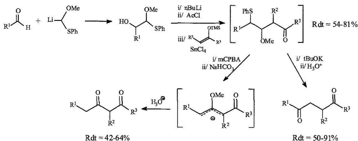
Ainsi, l'oxydation au mCPBA du précurseur suivie d'une thermolyse conduit après hydrolyse acide aux dicétones 1,3, tandis que le traitement successif au terbutylate de potassium et à l'acide permet l'obtention des dicétones 1,4 correspondantes.
