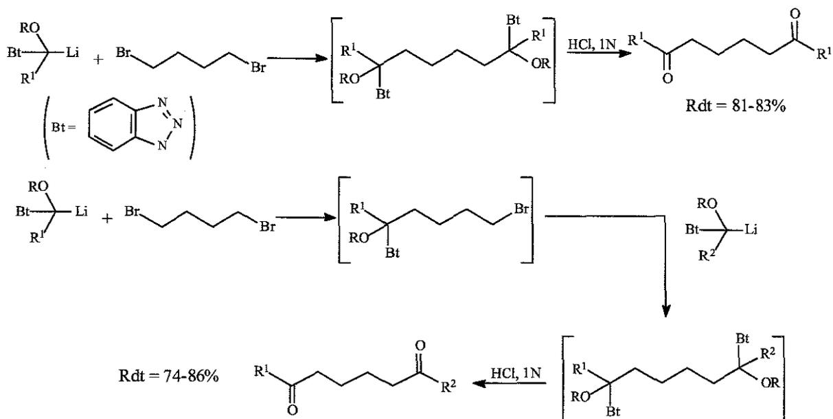
Ainsi, l'addition de deux équivalents de ce synthon lithié sur le 1,4-dibromobutane fournit après hydrolyse acide les dicétones 1-6 symétriques, tandis que l'attaque successive de deux lithiens différemment substitués sur le même biélectrophile fournit les dicétones dissymétriques correspondantes.
