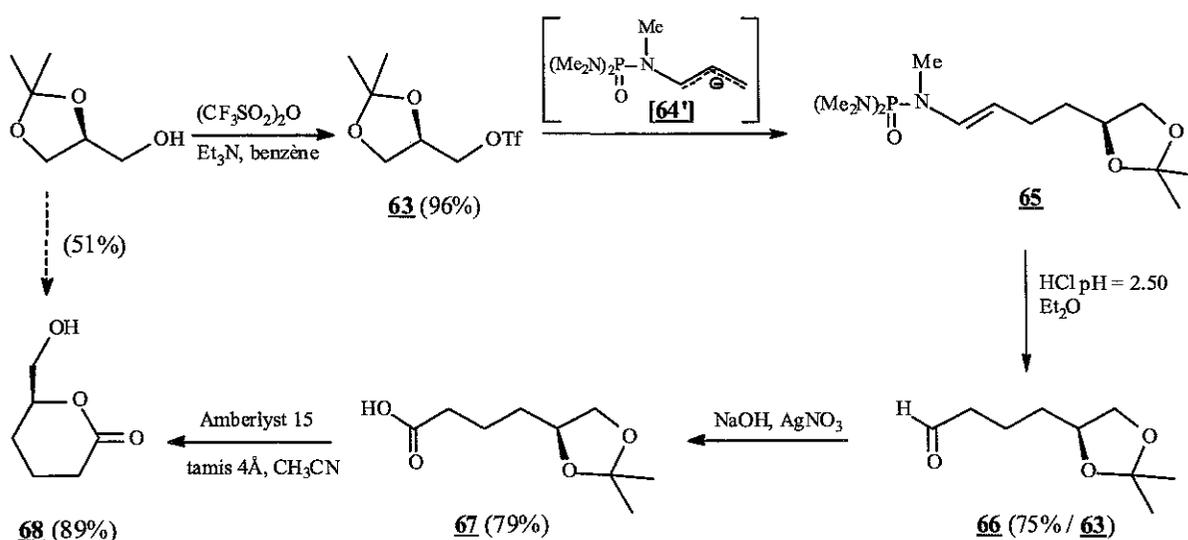
Ainsi le triflate **63** a été facilement synthétisé à partir du (S)-isopropylidène glycérol par traitement avec un équivalent d'anhydride trifluorométhanesulfonique et de triéthylamine dans le benzène. Cependant, cette étape est délicate et exige des précautions. De plus, le dérivé triflé doit être utilisé dans les 12 heures qui suivent sa préparation et conservé à basse température sous atmosphère inerte.
