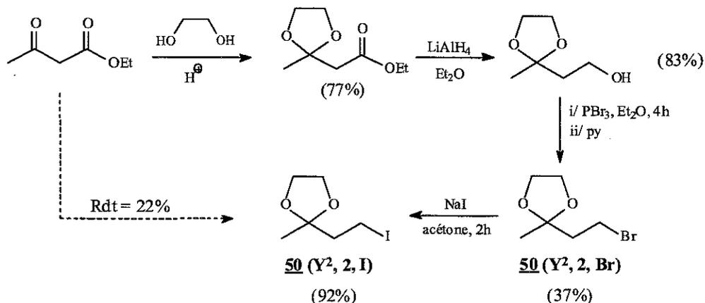
La réduction de la fonction ester en alcool par  $\text{LiAlH}_4$  s'effectue avec un très bon rendement. La deuxième étape qui consiste à bromer cet alcool par le tribromure de phosphore est par contre beaucoup plus délicate (schéma 128).
