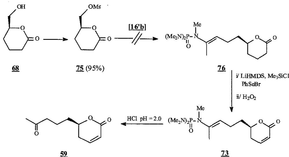
Le motif phosphoramide tiendrait ensuite le rôle de fonction protectrice de cétone lors de l'étape de sélénylation-oxydation du cycle lactonique et serait alors éliminé en fin de synthèse par hydrolyse acide contrôlée.
