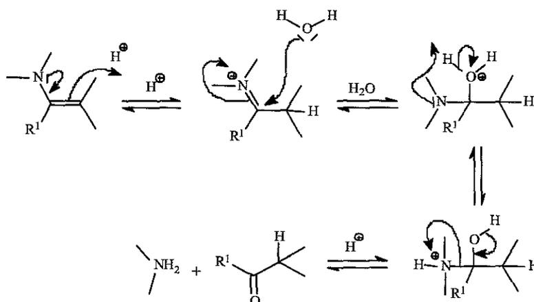
La difficulté d'hydrolyse des composés **39ai** comparée à celle des composés **39bi** ou **39ci** peut s'expliquer par la gêne stérique apportée par le groupe phényle qui rend plus difficile l'attaque de la molécule d'eau.
