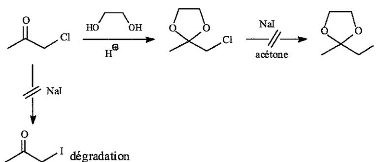
L'échange direct d'halogène à partir de la cétone chlorée commerciale échoue et conduit à la dégradation du milieu réactionnel. Cet échange ne se fait pas non plus comme cela était prévisible sur l'acétal cyclique du fait de l'encombrement stérique.
