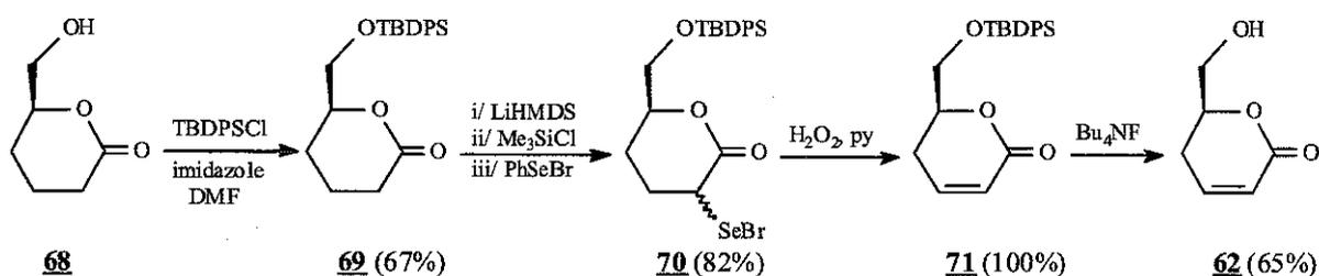
Ainsi, la fonction hydroxyle de **68** est préalablement protégée sous forme d'éther silylé par l'utilisation de chlorure de tertbutyldiphénylsilyle en présence d'imidazole dans le DMF.
