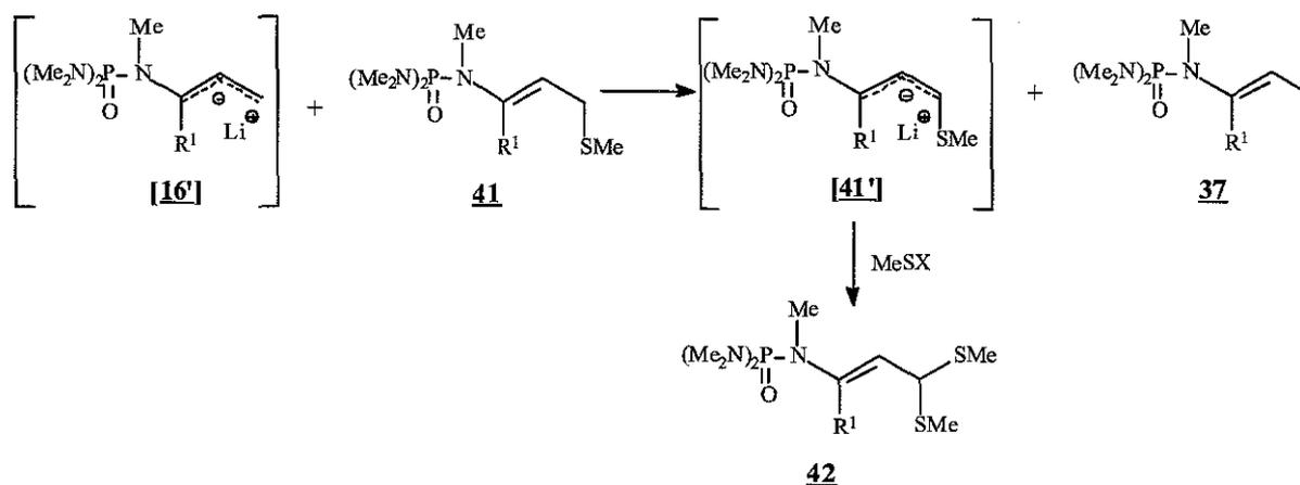
Or, il est connu que les anions dérivés des systèmes allyliques substitués par un soufre réagissent préférentiellement en  $\alpha$  de l'hétéroatome [50-53] avec les électrophiles. Ces effets s'ajoutant à ceux de la fonction phosphoramide orienteraient donc régiosélectivement en  $\gamma$  la réaction de **[41']** avec un nouvel équivalent d'électrophile de façon à produire le dithiocétal **42**.
