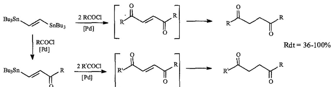
Les dicétones insaturées sont réduites *in-situ*, mais peuvent être néanmoins isolées si les conditions opératoires sont plus douces et que le temps de réaction est réduit.
