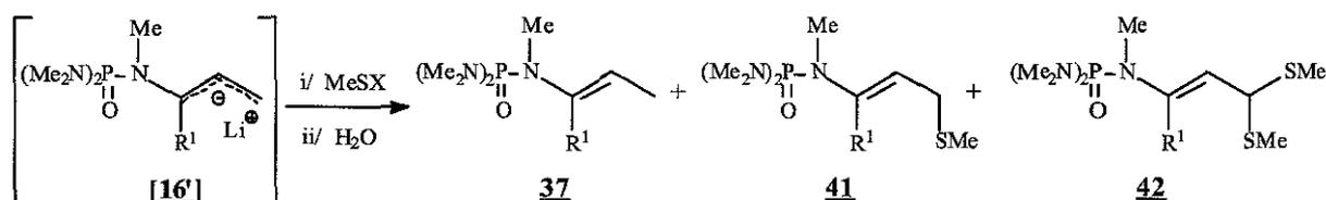
L'analyse RMN  $^1\text{H}$  et  $^{31}\text{P}$  des bruts ainsi obtenus met en évidence la formation de trois produits phosphorylés. Hormis le phosphoramide monosoufré attendu **41**, on détecte également la formation en quantité variable de produit transposé non soufré **37** accompagné de phosphoramide disoufré **42**.
