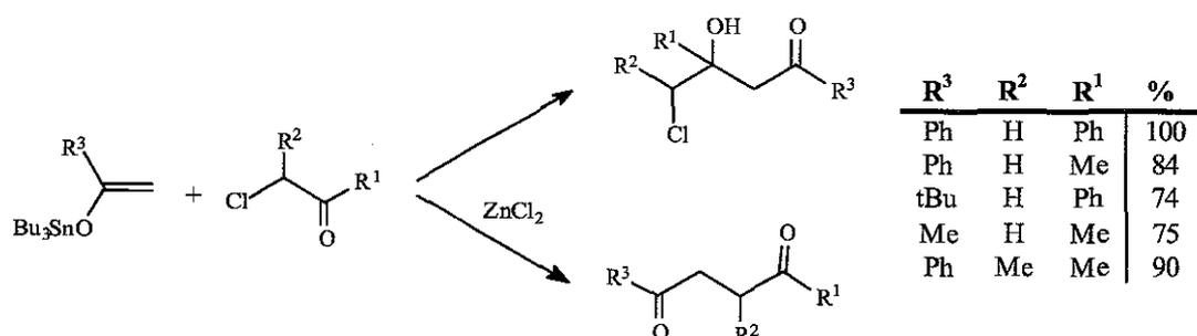
Alors que sans catalyseur le carbone du carbonyle est attaqué plus rapidement que le carbone halogéné, l'addition de dichlorure de zinc change complètement la régiosélectivité de la réaction et offre exclusivement les dicétones attendues.
