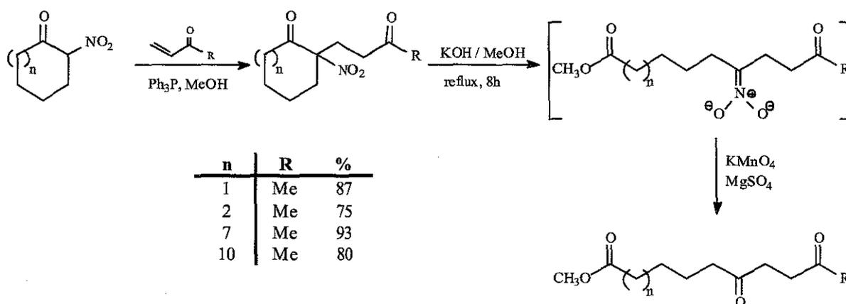
Ainsi, l'addition conjuguée des  $\alpha$ -nitrocétones cycliques sur l'énone en présence d'une quantité catalytique de triphénylphosphine fournit des nitrodicétones cycliques.
