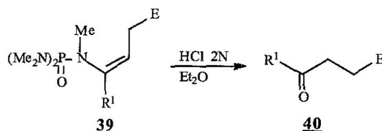
Les dérivés **39** sont préalablement dilués dans l'éther puis additionnés à une solution d'acide chlorhydrique 2N. Le mélange est agité vigoureusement à température ambiante jusqu'à stabilisation de la bande C=O observée en IR et la disparition du signal du phosphore en RMN  $^{31}\text{P}$  en « sweep-off ».
