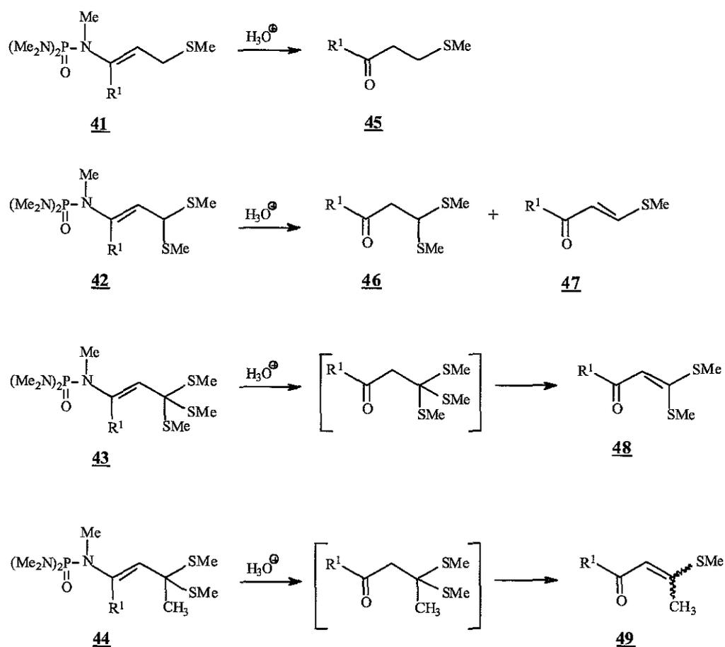
Ainsi, alors que l'hydrolyse du dérivé monosoufré 41 conduit à la cétone attendue 45, l'hydrolyse acide de l'ènephosphoramide dithiocétal 42 conduit dans tous les cas à la cétone 46, mais toujours accompagnée de la cétone insaturée 47 qui provient de l'évolution de la fonction dithiocétal de 46 en milieu acide.
