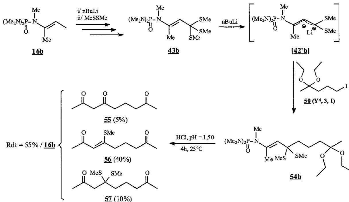
Ainsi, le dérivé trisoufré **43b** est préalablement préparé dans le même réacteur à partir de **16b** par traitement successif au butyllithium et au diméthylsulfure répété trois fois. Le dérivé **43b** est ainsi synthétisé avec un très bon rendement de 81%.
