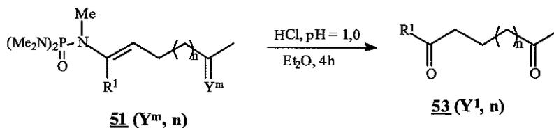
Après quatre heures de réaction à température ambiante, la réaction est totale. On neutralise alors le milieu réactionnel par une solution diluée de soude, et les composés dicarboxylés sont extraits à l'éther. Après évaporation du solvant, les bruts obtenus sont chromatographiés sur silice.
