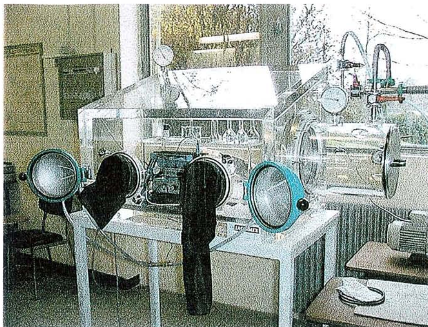
Figure I.14. : Photographie du caisson de pompage utilisé pour cette étude.
