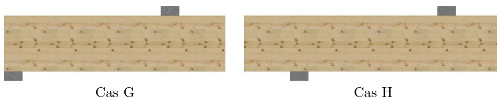
Figure I-20 : Configurations de chargement de compression perpendiculaire indirecte
