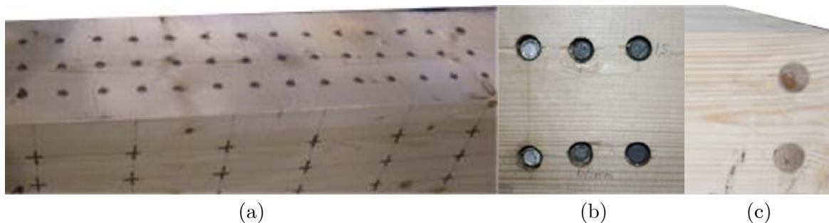
Figure I-32 : Renforcement de la compression perpendiculaire au fil par système de tige (a) [49] et (b,c) [52]
