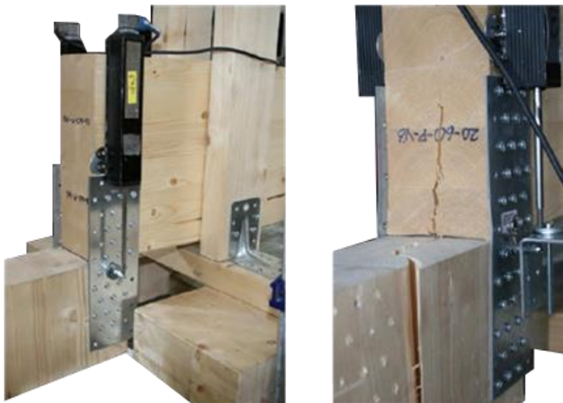
Figure I-30 : Renfort par plaque métallique [52]
