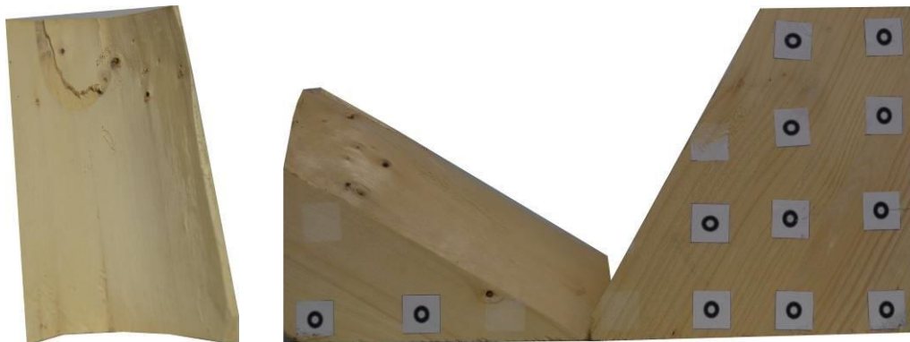
Figure II-47 : Rupture en cisaillement selon le sens parallèle au fil
