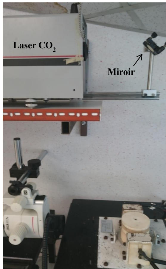
Figure II.11. Système de chauffage laser associé à l'appareillage \mu -PD
