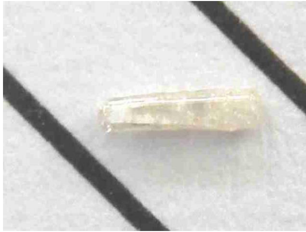
Figure III.37. Fibre de BZBO élaborée par \mu -PD avec une vitesse de 0,15 mm/h
