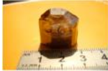
Figure I.12. Autre cristal de BZBO élaboré par la méthode de Czochralski 55
