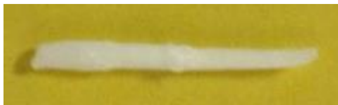
Figure IV.20. Fibre élaborée par la technique \mu -PD à partir du mélange LBGO-70%NaF-5%B 2 O 3
