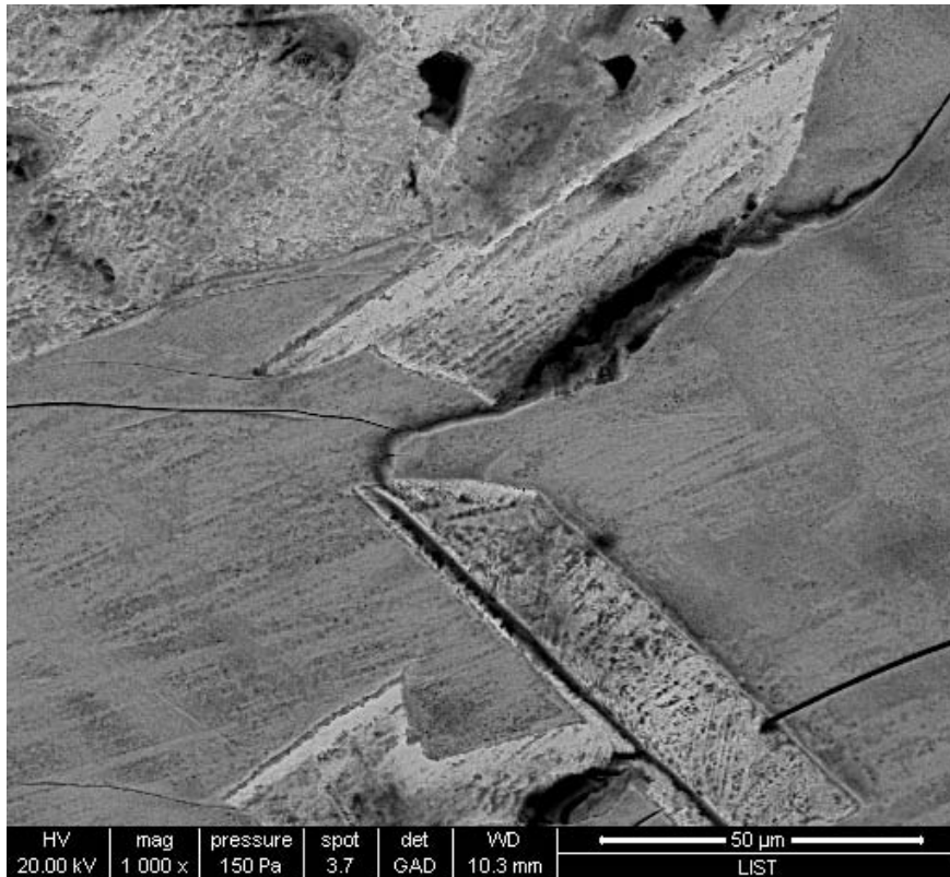
Figure V.8. Microstructure du cœur d'une fibre de BCBF tirée à une vitesse de 4,2 mm/h, observée par microscopie électronique
