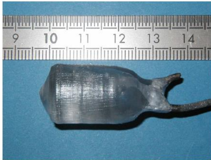
Figure I.34. Cristal de BCBF élaboré par la méthode de Czochralski 93
