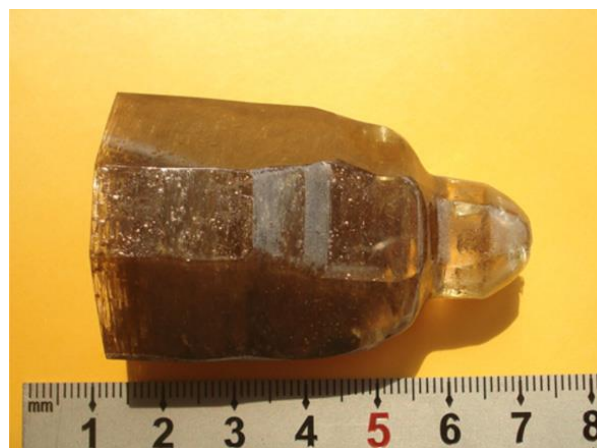
Figure I.11. Cristal de BZBO élaboré par la méthode de Czochralski 52
