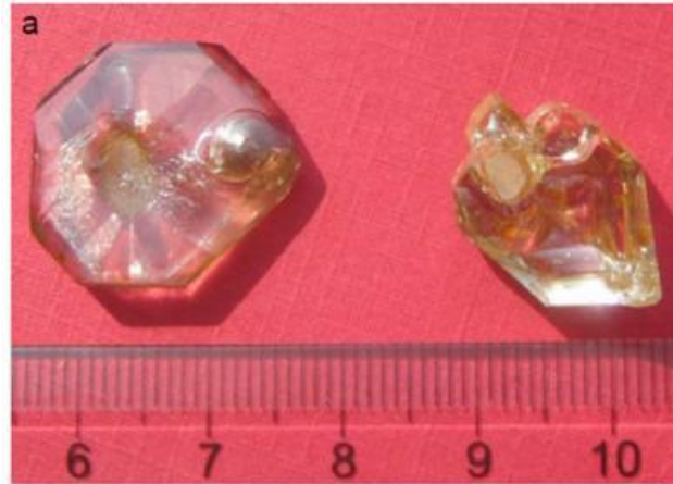
Figure I.7. Cristaux de BZBO élaborés par la méthode TSSG 53
