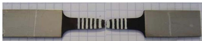
Figure II.9 – Photographie d'une éprouvette de CP Ti déformée jusqu'à la rupture. On peut noter une absence de la rotation des bandes peintes.
