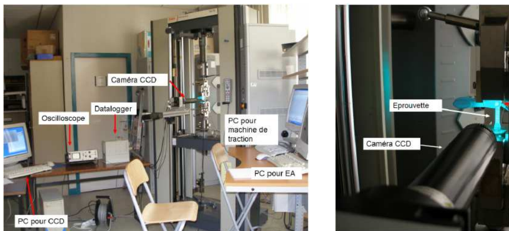
(a) Photographie de l'installation : Machine de traction-Extensométrie locale-Emission acoustique (b) Extensométrie locale. On voit une grille sur la surface de l'éprouvette (voir aussi la figure II.5)
