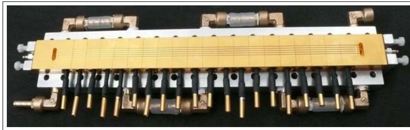
FIG. 3.22 – Cellule linéaire segmentée de 3 e génération. La plaque cathodique est composée de 20 segments électriquement indépendants (séparés par une feuille de PTFE). Les plaques anodique (non-segmentée) et cathodique sont en laiton doré et chacune d’entre-elles est déposée sur une plaque en dural. La grande conductivité thermique de ces matériaux assure une meilleur thermalisation de la cellule.
