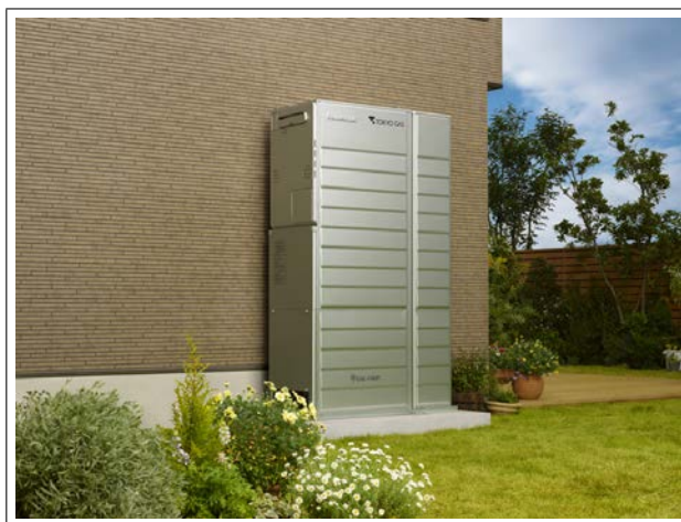
FIG. 1.10 – Pile à combustible Ene-Farm home fuel cell type PEM d’une puissance de 20 kW thermique et 200 à 700 W électrique développée par Tokyo Gas et Panasonic. Elle est destinée au chauffage et à la production d’eau chaude sanitaire pour une résidence individuelle. Ce modèle est également disponible avec une PàC type SOFC (20% des ventes contre 80% pour les PEMFC) [23].
