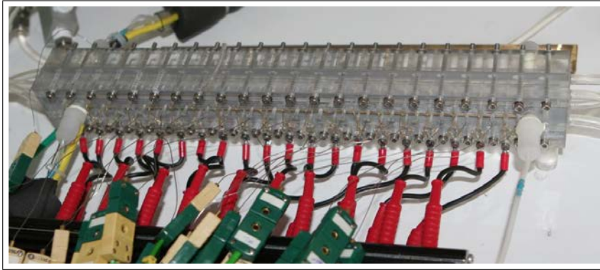
FIG. 3.17 – Cellule linéaire de 1 ère génération constituée de 20 segments électriquement indépendants. La collecte du courant est réalisée par des fils d'or disposés sur la périphérie de la surface active. Pour chaque segment, la dent du canal central est équipée d'un thermocouple.
