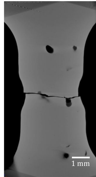
Figure 77 : coupe tomographique de l'échantillon de P60 - 4 (taux de porosité : 1,31 %). La zone de rupture passe par deux porosités situées au sein du VER.
