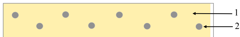
Figure 30 : représentation schématique des 8 points d'injection d'air (2) pour les échantillons (1) du groupe 2.
