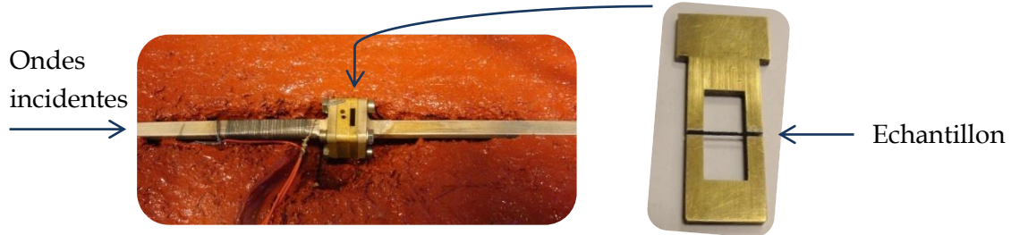
Figure 171 Guide d'onde de section 7.2 \times 3.4 \text{ mm}^2 fonctionnant dans les fréquences de 26 à 38 GHz, avec à droite le porte-échantillon où l'échantillon (en noir) est inséré.
