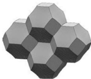
Figure 2 Empilement de cellules de Kelvin (ou tétrakaidécaèdre).
