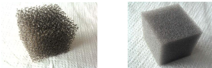
Figure 84 Mousses polyuréthanes réticulées CUSTOMFOAM à 30 PPI (à gauche) et 80 PPI (à droite).
