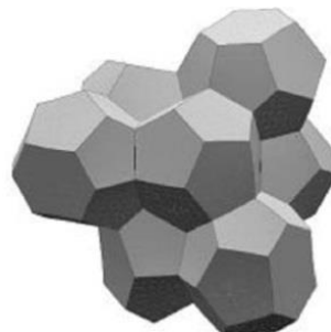
Figure 3 Empilement de cellules de Wheaire et Phelan.
