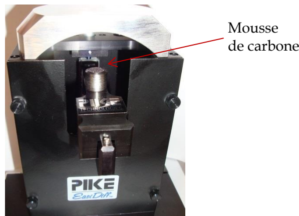
Figure 190 Système Pike EasiDiff Diffuse reflectance inséré à la place du porte-échantillon dans le spectromètre Vertex 80 pour effectuer les tests en réflexion.
