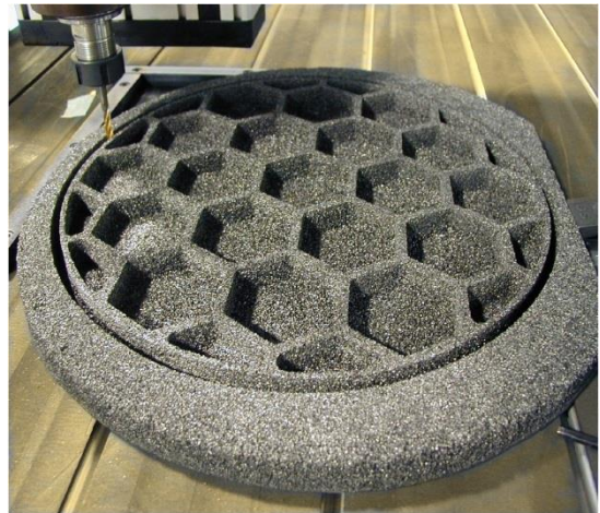
Figure 16 Usinage de nids d'abeilles à partir de mousses CFOAM [41].
