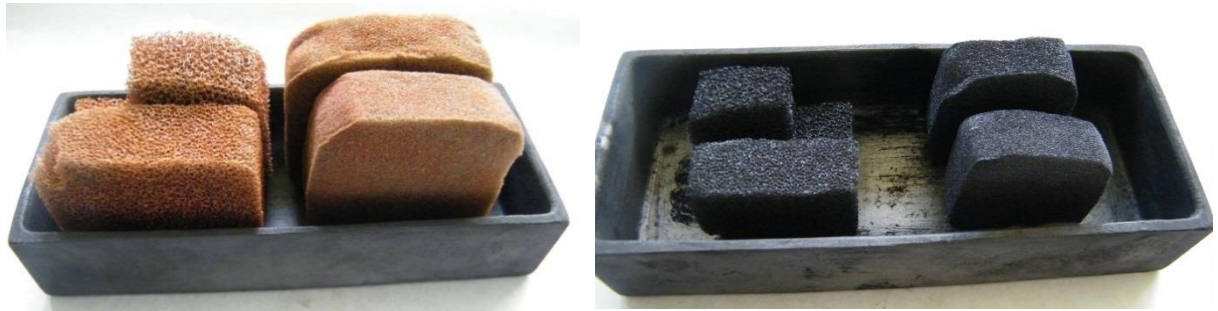
Figure 90 Mousse CUSTOMFOAM après thermo-polymérisation du gel RF (à gauche), et après pyrolyse (à droite).
