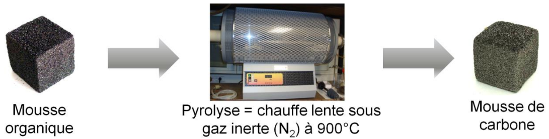
Figure 33 Transformation des mousses de tannin en mousses de carbone.
