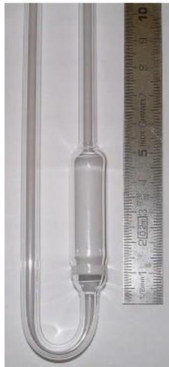
Figure 4.3: Réacteur piston utilisé
