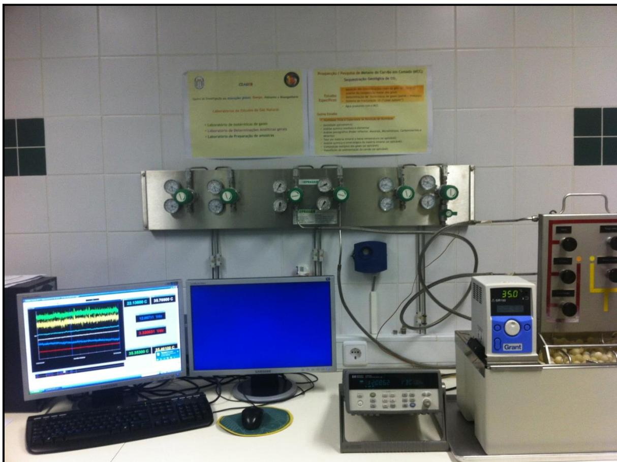
**Figura 25. Fotografia de instrumento de medición de Adsorción/Desorción por el método termo-volumétrico.
