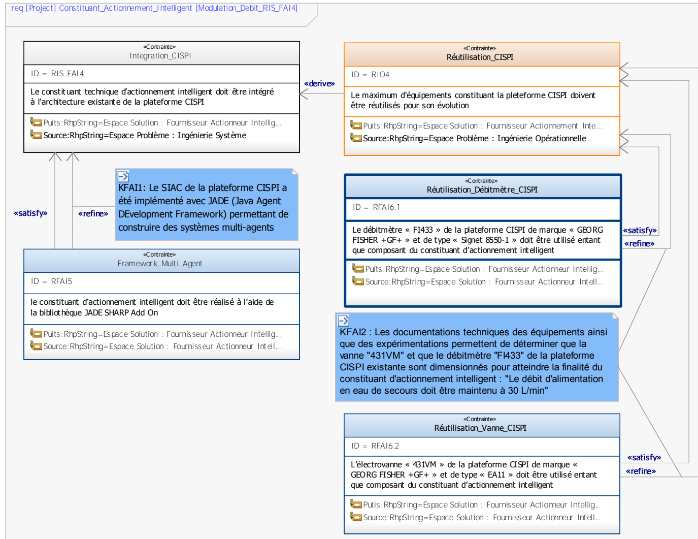
Figure 132 : Diagramme d'exigences (req) SysML - Raffinement de l'exigence système ( R_{IS\_FAI4} ) par l'espace-solution fournisseur d'actionneur intelligent
