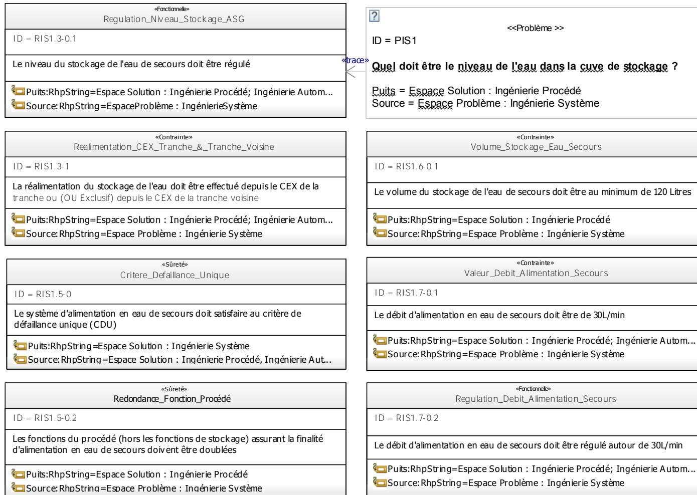
Figure 191 : Diagramme d'exigences SysML - Exigences et problèmes systèmes ( R IS Pro SysML ) relatives au procédé
